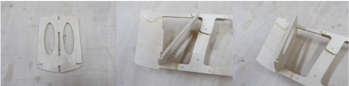
Spant 29 wird vorne montiert. Dazu wird er schräg in die Ausnehmung eingebracht und unten mit dem Schlitz auf den Steven gesteckt (mittleres Bild). Der Spant wird aufgerichtet bis er am Vorsteven spaltfrei anliegt (rechtes Bild).
