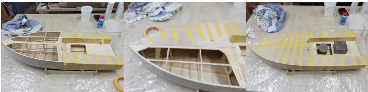
Nachdem Einkleben des Cockpitbodens werden die beiden hinteren Decksbeplankungen 45 so aufgebracht, dass sie innen und am Spiegel bündig anliegen. Seitlich stehen sie etwas über. Danach folgt die rechte Vordeckshälfte 46 und die linke Vordeckshälfte 47. Viel Klebeband und Gewichte helfen, dass die Verklebung während des Aushärtens des Harzes überall anliegt.
