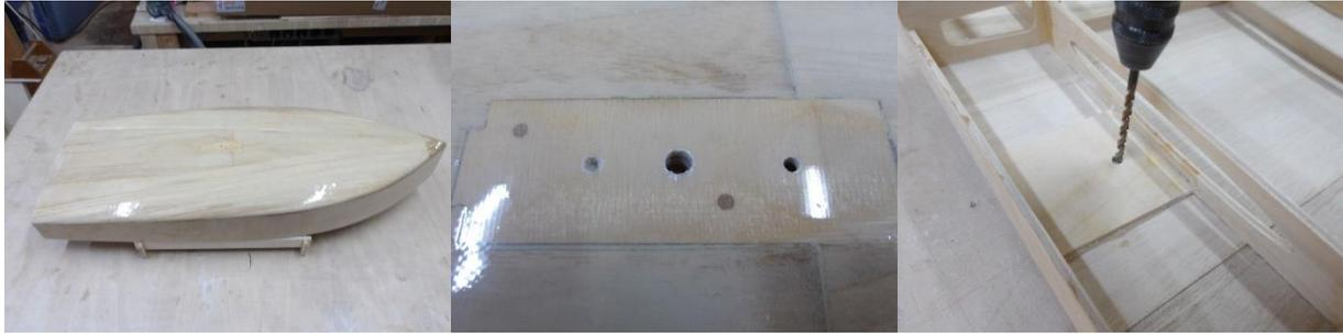
Der Rumpf wird anschließend mit GfK beschichtet. Nach dem Aushärten des Harzes werden die Bohrungen in der Kielplatte 37 wieder geöffnet. Das mittlere Loch nimmt später die Kielschraube auf, die beiden kleinen Löcher dienen dem Ausrichten des Kiels. Auch die Bohrung für den Ruderkoher wird von innen geöffnet.
