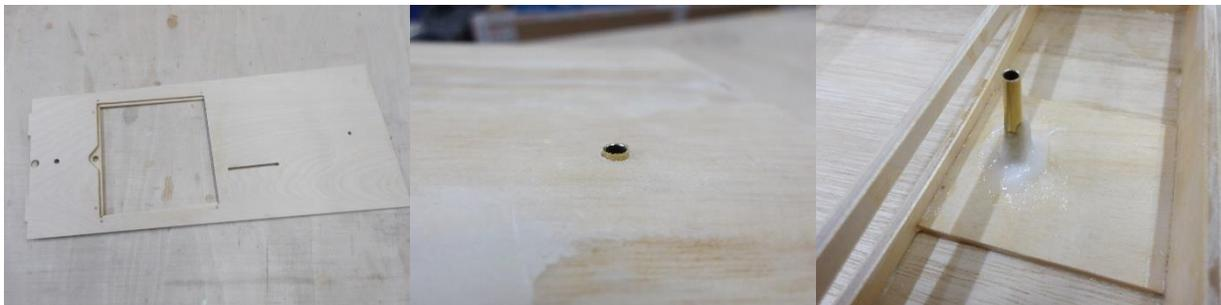
Mit Hilfe des Cockpitboden wird der Ruderkoher ausgerichtet. Dazu wird das Bodenbrett provisorisch montiert, der Ruderkoher so positioniert, dass er 1 mm über den Rumpfboden hinaussteht und mittels Sekundenkleber von unten festgeklebt. Nach dem Aushärten des Klebers wird der Cockpitboden entfernt und der Ruderkoher mit angedicktem Epoxid-Harz von innen verklebt.
