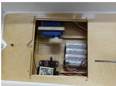
Empfänger und Akku werden mit selbstklebendem Klettband befestigt.
