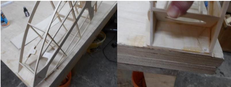
Der Rumpf wird mit dem Vorsteven so auf die Beplankung gedrückt, dass der Vorsteven mit ihr abschließt. Etwas warten, bis der Sekundenkleber ausgehärtet ist und dann den Rumpf auf die Beplankung rollen. Die Beplankung liegt auf allen Spanten und Stringern spaltfrei an.
