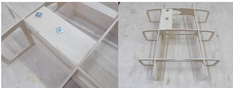
Gefühlvoll werden die beiden Spanten ganz in die Schlitz gedrückt. Dabei soll das Segelwindenfundament in die Ausnehmung der Cockpitseitenwand einrasten. Das rechte Bild zeigt die Ansicht von hinten. Das Segelwindenfundament muss auf der linken Seite liegen.
