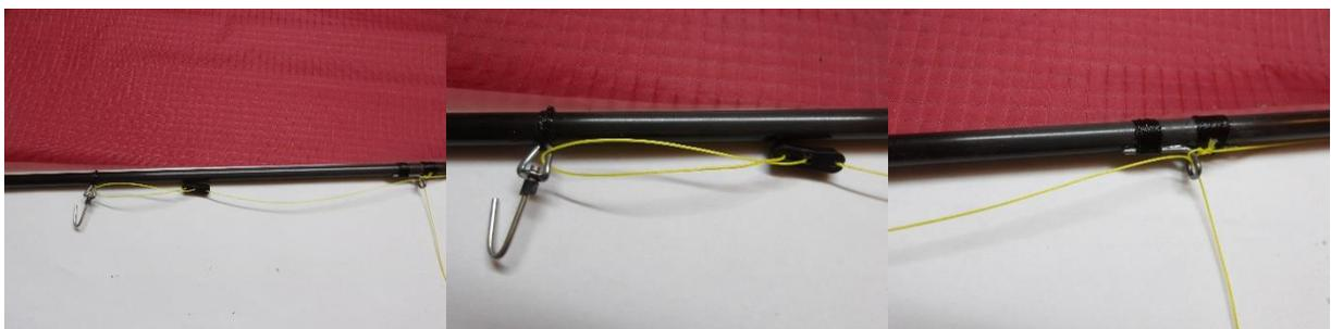
Die Schot bekommt wieder einen Klemmschieber und wird wie auf den Bildern gezeigt geführt. Das lose Ende sollte etwas, nach vorne geführt, etwas über den Fockbaum überstehen.
