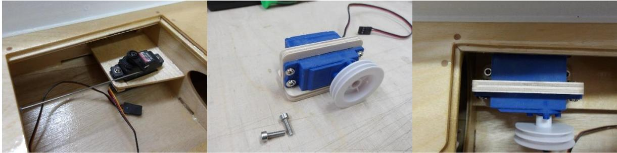
Das Ruderservo wird montiert, auf Mitte gestellt und der Ruderhebel zusammen mit einem gekröpften 1,5 mm Draht, der durch das Bodenzugrohr geführt ist, montiert. Die Segelwinde wird in ihre Halterung geschraubt und mit zwei M3 x 10 mm Imbus-Schrauben auf dem Windenfundament montiert.
