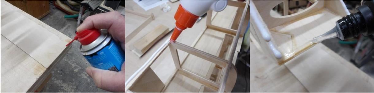
Die Seitenbeplankung aus 1 mm Flugzeugsperrholz wird auf die Werkbank gelegt und am Bug Aktivator Spray aufgesprüht. Die Stringer und Spanten werden mit Weißleim versehen und der Vorsteven mit dickflüssigem Sekundenkleber.
