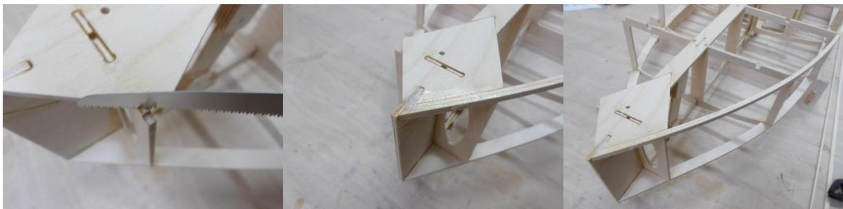
Die Ausnehmungen in den Spanten, die die Seitenstringer aufnehmen, werden entsprechend der Schräge angepasst. Der erste Seitenstringer, bestehend jeweils zwei aus 5 x 2 mm Kieferleisten, die aufeinander geleimt werden, wird angebracht. Wieder ist auf exakte Ausrichtung des Rumpfes auf dem Ständer zu achten.
