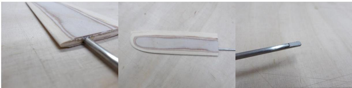
Das Ruderblatt wird anschließend profiliert und der Schaft am oberen Ende mit einer Abflachung versehen, die nach hinten zeigt.
