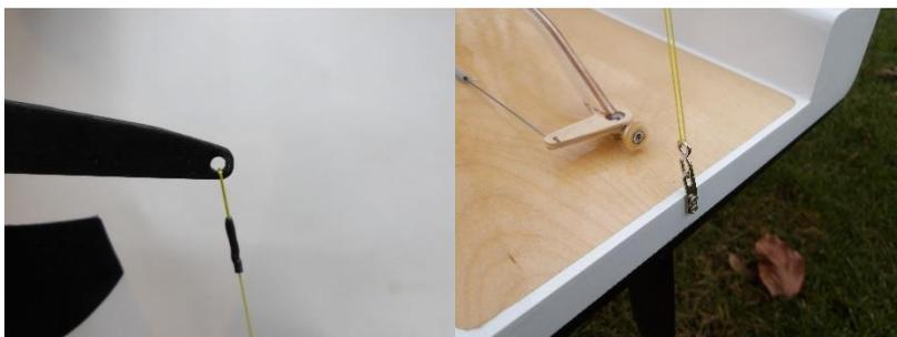
Das Achterstag wird am hinteren Ende des Kopfbretts angeknüpft, ebenfalls durch einen S-Haken am Heck geführt und an einem Klemmschieber verknotet. Mit dem Achterstag wird die Mastkurve und die Vorstagspannung eingestellt. Es wird jetzt ebenfalls leicht durchgesetzt und danach der Vorliekspanner der Fock leicht gespannt. Die Vorliekspannung der Fock sollte vorsichtig eingestellt werden, da sich das Segel sehr leicht verziehen kann.
