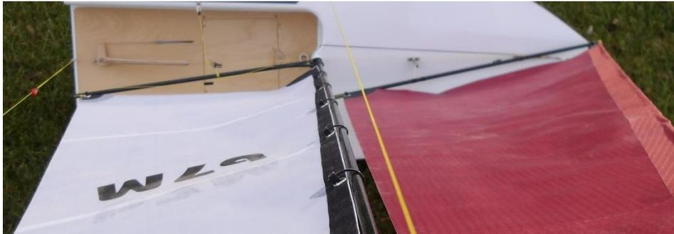
Das Großsegel sollte in der dichtgeholten Stellung so dicht wie möglich mittig stehen. Die Fockschot wird für die Jungfernfahrt so eingestellt, dass die Fock etwa 5 ° weiter geöffnet ist, als das Großsegel. Später kann dieser Trimm noch nach eigenem Geschmack geändert werden.
