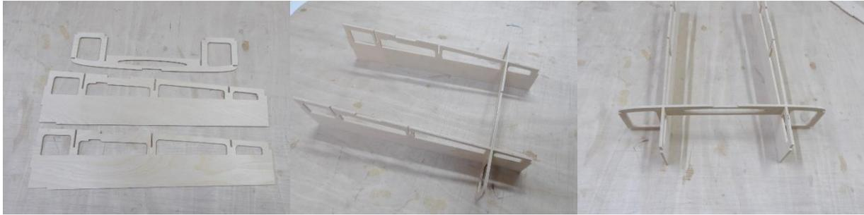
Begonnen wird mit den Cockpitseitenwänden 15, in die Spant 16 kopfüber in den hintersten Schlitz gesteckt wird.
