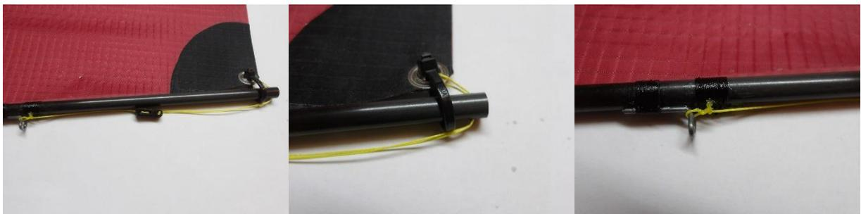
Das Schothorn wird analog zum Großsegel befestigt. Der Unterliekstrecker wird an der Schotöse festgeknotet.
