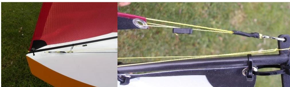
Die Fock wird in die U-Öse auf dem Vordeck eingehängt und am Masttopp mit einem S-Haken befestigt. Zuerst wird das Vorstag am Haken festgeknotet, wobei der Mast nicht nach vorne gebogen werden darf. Dann kommt der Vorliekstrecker. Er bleibt zunächst noch locker.
