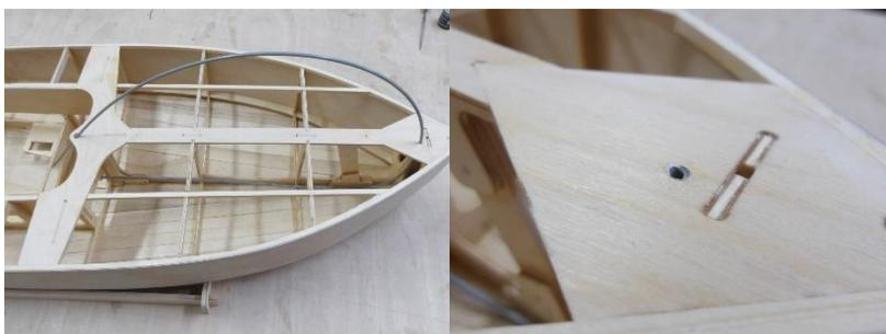
Am einfachsten ist das zu erreichen, wenn man das Bowdenzugrohr durch die Mastöffnung im Deck führt und es in diesem Zustand an allen Kontaktstellen verklebt. Nach dem Aushärten des Klebers wird es bündig mit dem Deck abgeschnitten.
