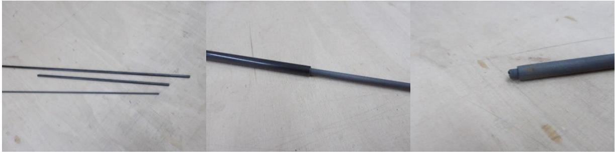
Zur Herstellung des Masts wird das 4 mm CfK-Rohr so in das untere Mastteil eingeklebt, dass es unten 5 mm hervorsteht.
