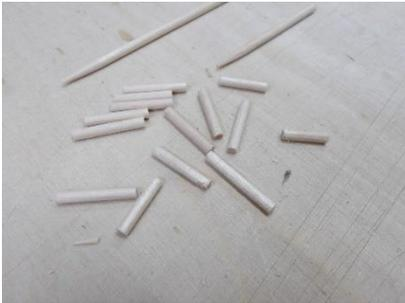
Zunächst werden aus den Rundhölzern kurze Stücke mit 10 – 15 mm Länge hergestellt. Sie dienen später der Positionierung der Bauteile zueinander.
