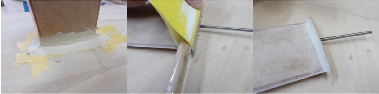
Mit Füllspachtel wird die Hohlkehle großzügig ausgespachtelt. Nach dem Aushärten des Spachtels wird die Hohlkehle geschliffen. Ein um einen Rundstab gewickeltes Schleifpapier ist hier die einfachste Möglichkeit eine saubere Rundung zu erzeugen.
