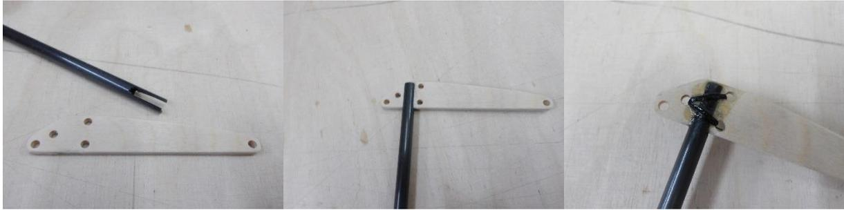
Am Masttopp wird ein 3 mm breiter Schlitz angebracht, Teil 53 eingeklebt und mit Bindfaden wie abgebildet vernäht und verklebt.
