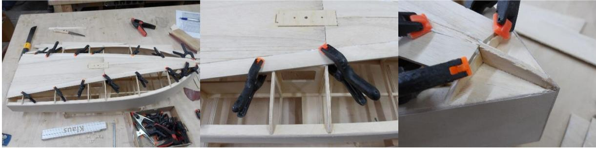
Ab jetzt wird mit 15 mm breiten Planken weiter beplankt, die sehr leicht mit einem Balsaschneider selbst hergestellt werden können. Der Bugbereich wird nicht beplankt.
