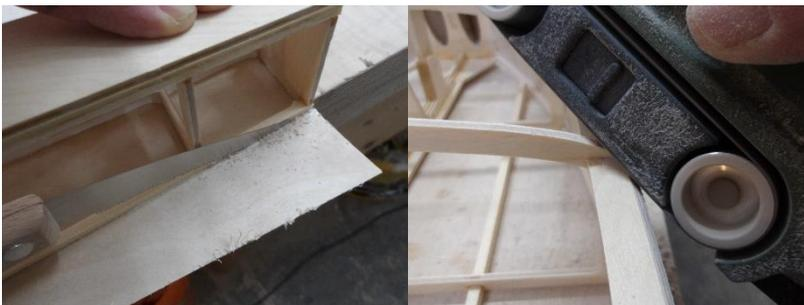
Nach dem Aushärten des Klebers werden die Überstände abgesägt und der Kimmstringer 34 entsprechend der Spanten schräg angeschliffen.
