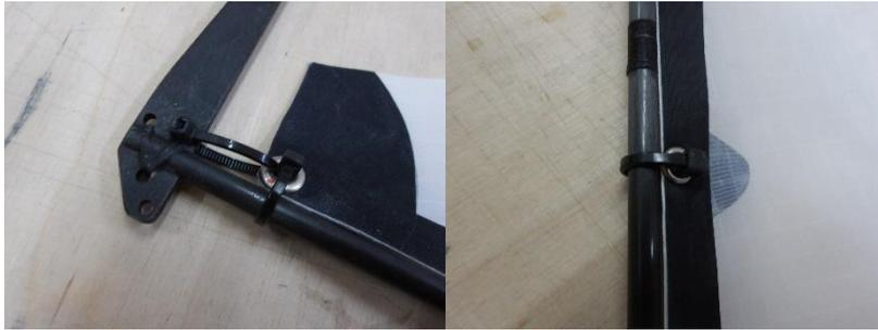
Das Großsegel wird mit Kabelbindern am Mast und am Masttopp angeschlagen. Die Kabelbinder werden möglichst gleichmäßig so zugezogen, dass sich das Segel frei am Mast bewegen kann und etwa 10 mm Abstand zum Masttopp gegeben sind.
