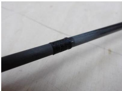
Das obere Mastteil wird von oben auf das über das untere Mastteil überstehende 4 mm Rohr geschoben, mit Bindfaden umwickelt und verklebt.
