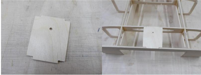
Teil 21 ist die Halterung des Ruderkokers. Sie wird am Heck zwischen dem Spiegel und Spant 16 eingebaut.
