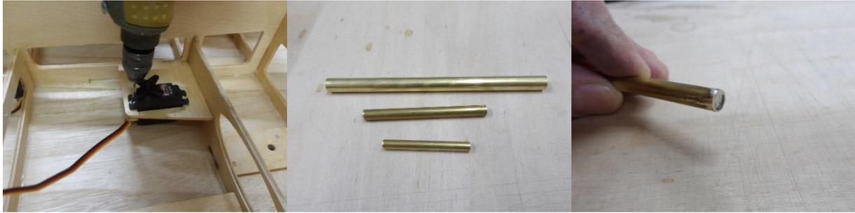
Die Befestigungsbohrungen für das Ruderservo werden angebracht und die drei Hülsen für den Mastfuß, die Kielaufnahme und den Ruderkoher vorbereitet. Die Masthülse wird am unteren Ende mittels 2-Komponentenkleber oder Lötzinn verschlossen.
