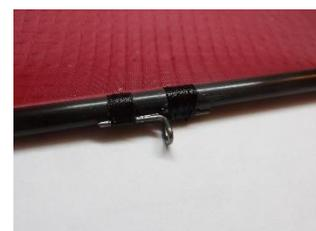
Die Befestigung erfolgt mit mehreren Windungen Bindfaden, der nach dem Festbinden mit dünnflüssigem Sekundenkleber getränkt wird.
