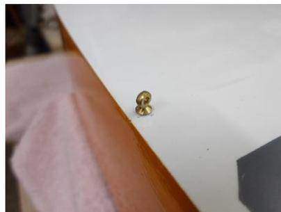
Zur Befestigung der Wanten werden zwei Augbolzen im Abstand von 419 mm vom Bug und 5 mm von der Deckschante angebracht.
