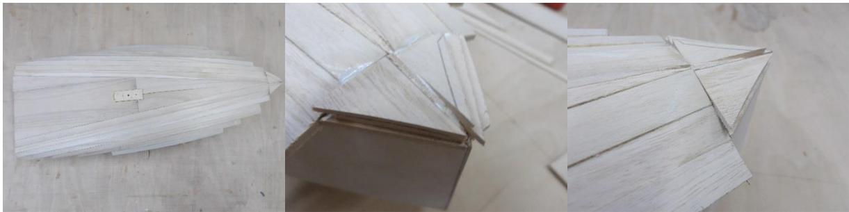
Seitlich darf die Beplankung großzügig über die Seitenplanken überstehen. Der Bugbereich wird mit mehreren Schichten aus Reststücken geschlossen.
