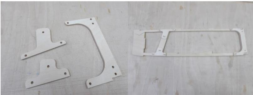
Mit den zweiten Teilen 23, 25 und 27 wird der Vorsteven vervollständigt. Auf einem ebenen Baubrett werden die Teile miteinander verklebt. Nach dem Aushärten des Klebers werden die überstehenden Rundholzstückchen bündig abgesägt.
