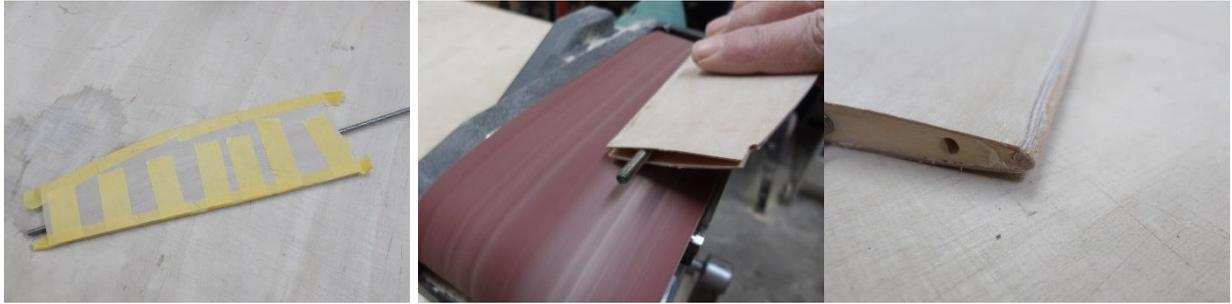
Die zweite Beplankung 43 wird nun mit der Einheit verklebt und nach dem Aushärten des Klebers verschliffen.
