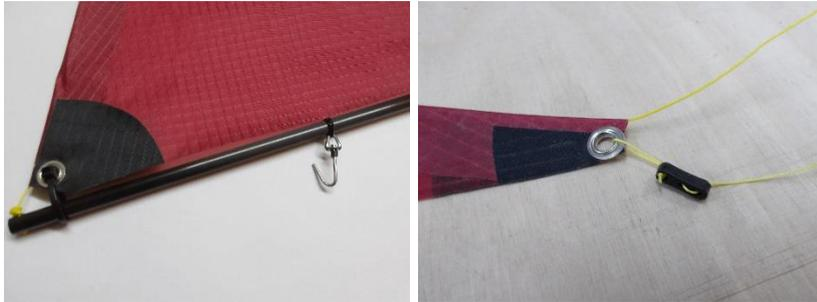
Der Hals des Vorsegels wird mit einem Kabelbinder am Fockbaum befestigt, das Vorstag an der vorderen Bohrung des Baums festgeknotet und durch die Vorliektasche des Vorsegels gezogen. Es wird oben etwa 20 cm Überstand gelassen und ein Klemmschieber angebracht, um das Vorliek später spannen zu können.
