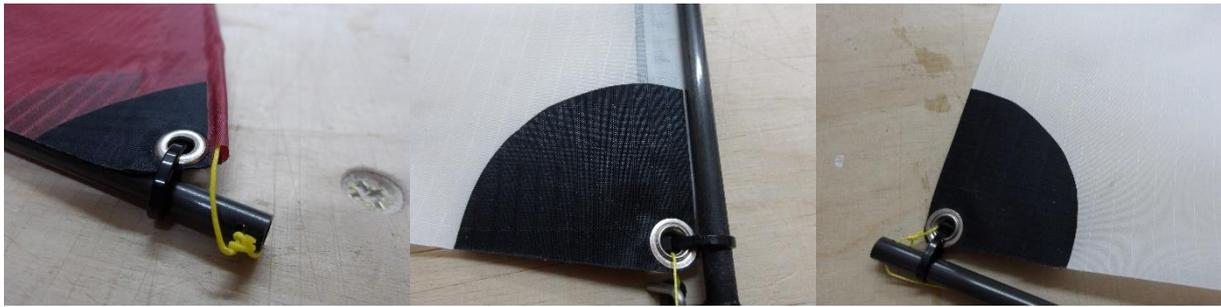
Die Vorlieke werden entsprechend der Kontur um gefalzt und mittels 6 mm breitem doppelseitigem Klebeband verklebt. Beim Vorsegel entsteht dadurch eine Tasche, in die später das Vorstag eingefädelt wird. Beim Großsegel wird lediglich das Vorliek verstärkt, ohne Tasche. Die Ecken werden mit selbstklebendem Segeltuch verstärkt und Löcher angebracht. Einschmelzen mit dem LötKolben genügt, Hohlriete sind schöner.
