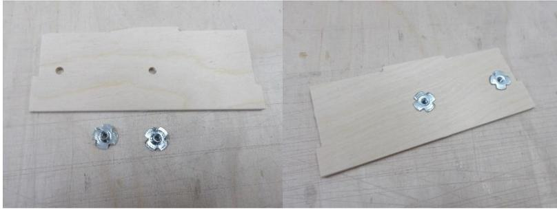
Teil 6 stellt das Fundament für die Segelwinde dar. Von der Unterseite werden zwei Einschlagmuttern eingepresst und verklebt.
