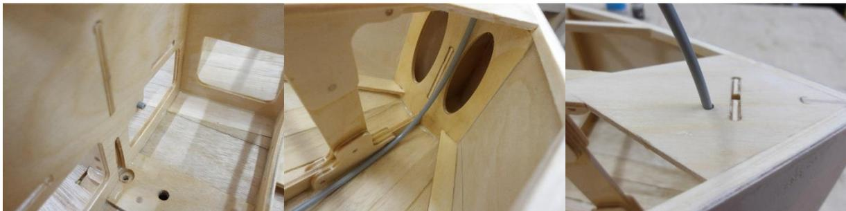
Das Bowdenzugrohr für die Schotführung wird angebracht. Im Inneren soll es ein klein wenig über den Hauptspant hinausstehen. Vorne soll es am Kiel und am Bugspant anliegen und schräg nach hinten geneigt aus dem Deck austreten.
