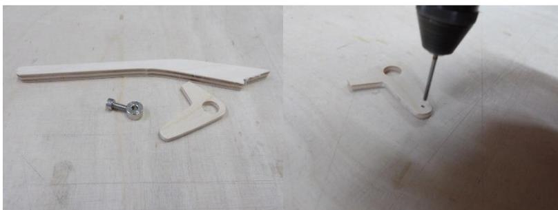
Die Ruderanlenkung entsteht aus den Teilen 50 und 51, sowie aus dem Stelling mit der M3-Imbusschraube. In den Ruderhebel wird, wie im rechten Bild gezeigt, eine 1,5 mm Bohrung eingebracht.
