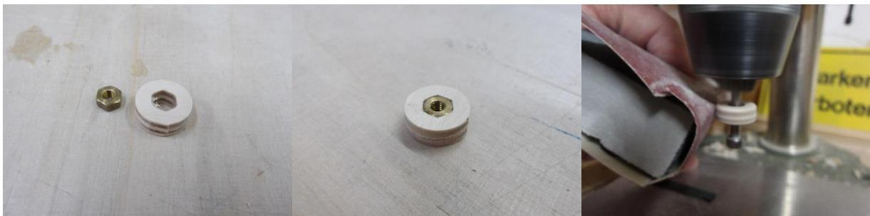
Die M4 Mutter wird in Teil 49 eingeklebt. Nach dem Aushärten des Klebers wird Teil 49 in der Bohrmaschine rund geschliffen.
