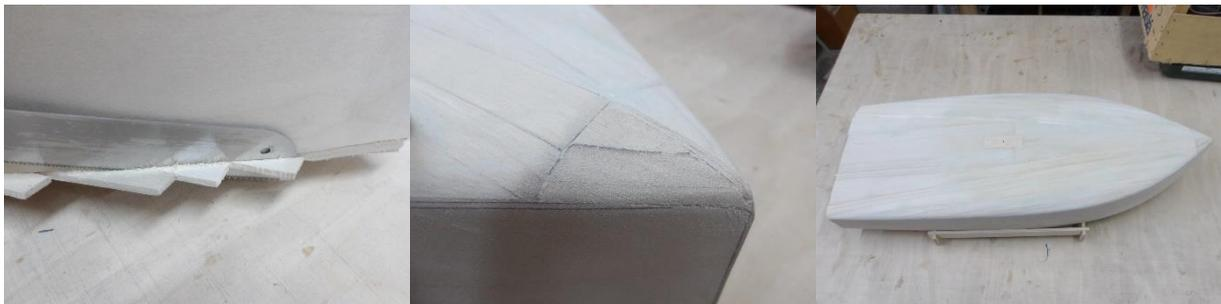
Die Überstände der Planken werden abgeschnitten und der Rumpf verschliffen.
