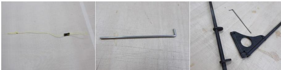
Aus Schotmaterial wird ein 16 cm langer Strecker mit einem Klemmschieber hergestellt. Ein 2 mm Stahldraht wird oben senkrecht abgewinkelt und so abgelängt, dass er etwas länger ist, als der Abstand zwischen den beiden Baumgelenken.
