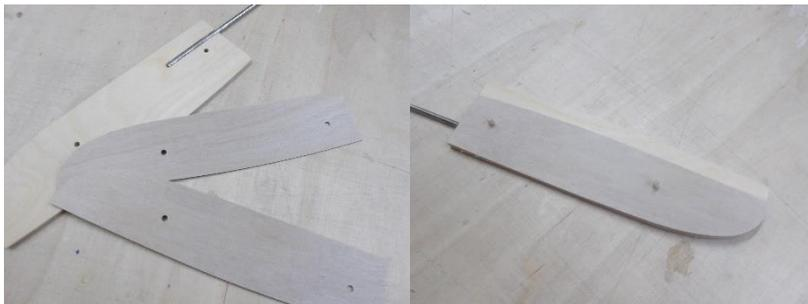
Die Ruderblattbeplankung 39 wird mit Hilfe von zwei 3 mm Rundstücken positioniert und flächig mit dem Ruderblatt verklebt.
