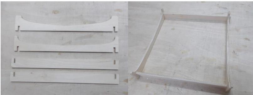
Aus den Teilen 1 – 3 entsteht der Ständer. Er wird lediglich zum geraden Aufbau des Rumpfes und zu dessen Ausbau benötigt. Am See verwendet man besser einen Scherenständer.
