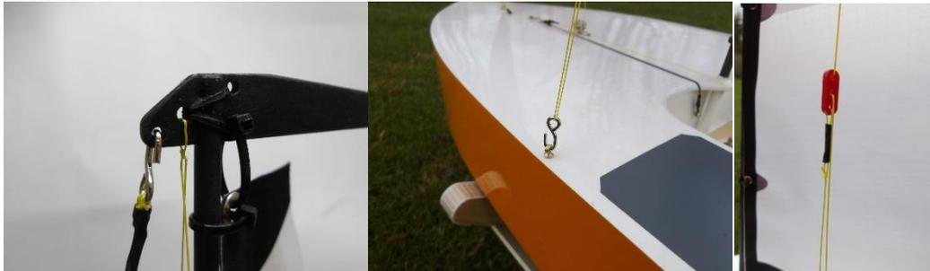
Die beiden Wanten werden am Masttopp verknotet, durch einen S-Haken geführt und an einem Klemmschieber befestigt. Die Wanten werden mit dem Klemmschieber leicht gespannt.
