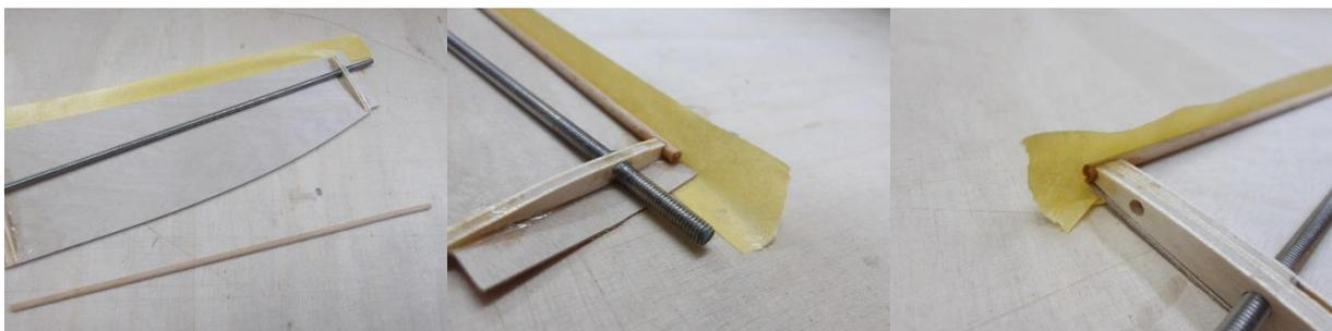
Der 3 mm Buchenrundstab wird in die Ausnehmungen der Rippen gedrückt und auf einer ebenen Platte mit der Beplankung verklebt. Ein Klebestreifen verhindert dabei das Verkleben mit der Unterlage.
