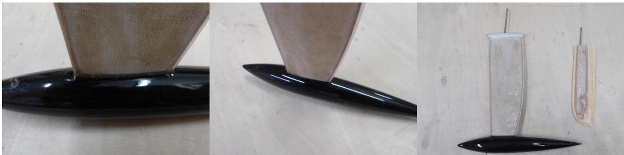
Der Ballast wird angeschraubt und mit 2-Komponenten-Kleber mit dem Schwert verklebt. Nach dem Imprägnieren des Ruderblatts mit Epoxid-Harz können beide Teile geschliffen werden.
