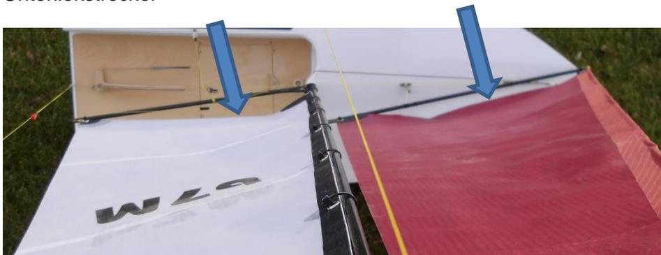
Mit dem Unterliekstrecker kann der Bauch des Segels beeinflusst werden. Das Segel darf nie strammgezogen werden, es soll immer etwas durchhängen. Der Bauch von Fock und Groß sollte in etwa gleich groß sein.
