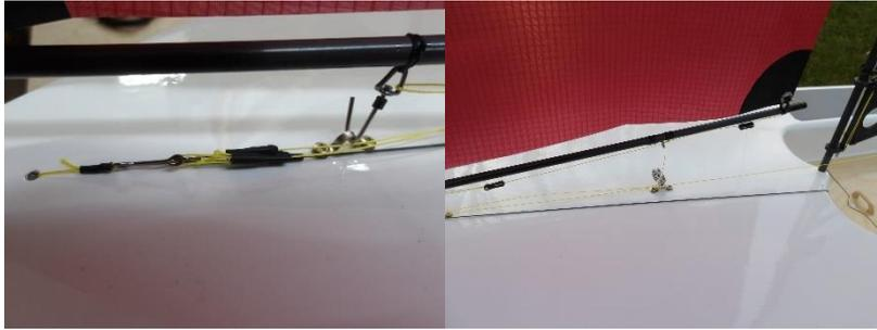
Die Fockschot wird durch den Senkrechtblock nach vorne geführt und erhält am Ende eine Schlaufe, die ebenfalls in den Schnellverschluss der Schot, die von der Winde kommt, eingehängt wird. Der Schnellverschluss wird zum Segeln immer geschlossen, damit die Schoten sich nicht aushängen können.
