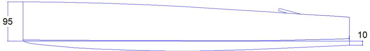
Soll das Unterwasserschiff in einer anderen Farbe lackiert werden als das Überwasserschiff, kann die Lage der Wasserline obiger Zeichnung entnommen werden.
