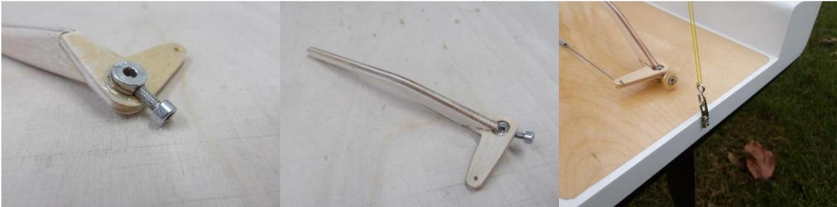
Die Pinne 51 wird angeklebt und verschliffen. Das rechte Bild zeigt die fertige Einheit. Optional kann Teil 55 auf den Schraubenkopf geklebt werden. Es erleichtert das werkzeuglose auf und Abrüsten des Modells (rechtes Bild).
