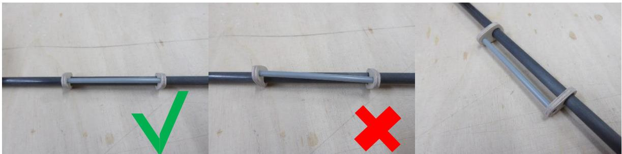
... mittels eines entsprechend abgelängten Bowdenzugrohrstücks ausgerichtet und und alle Teile miteinander mit dünnflüssigem Sekundenkleber verklebt.
