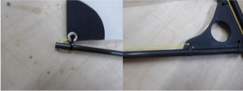
Das Schothorn des Großsegels wird ebenfalls mit einem Kabelbinder locker am Baum befestigt. 5 mm vom Ende des Baums wird ein 2 mm Loch gebohrt, durch das der Unterliekstrecker geführt wird. Er wird an der Baumnock festgeknotet.
