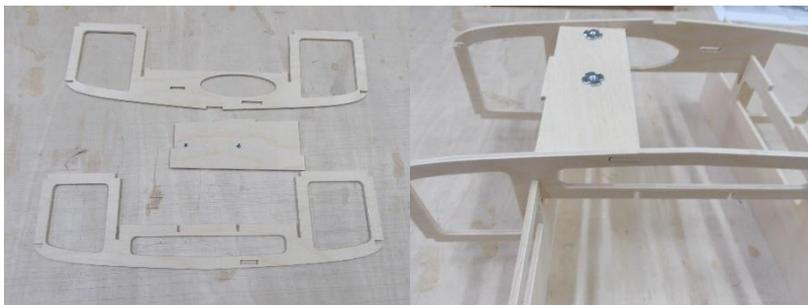
Die Spanten 17 und 18 werden nun zusammen mit dem Segelwindenfundament montiert. Dazu werden die beiden Spanten, wie im rechten Bild zu sehen, nur halb in den Schlitz der Cockpitseitenwände eingeführt, sodass das Segelwindenfundament in den Schlitz der beiden Spanten eingeführt werden kann.
