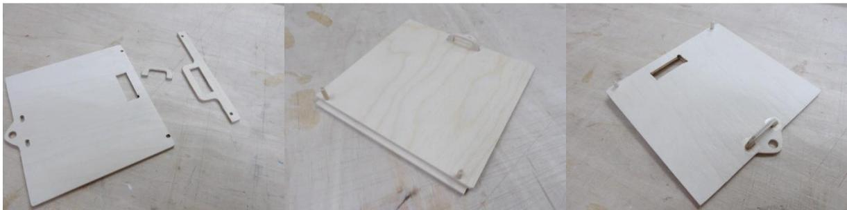
Aus den Teilen 9 – 11 entsteht der Deckel im Cockpitboden. Kurze Rundholzstückchen helfen beim Ausrichten von Teil 9 und 11. Nach dem Aushärten des Klebers wird der Überstand bündig mit der Oberfläche abgelängt. Optional kann der Deckel 9 später mit einer Öffnung für ein Servo als Sonderfunktion versehen werden (rechtes Bild).
