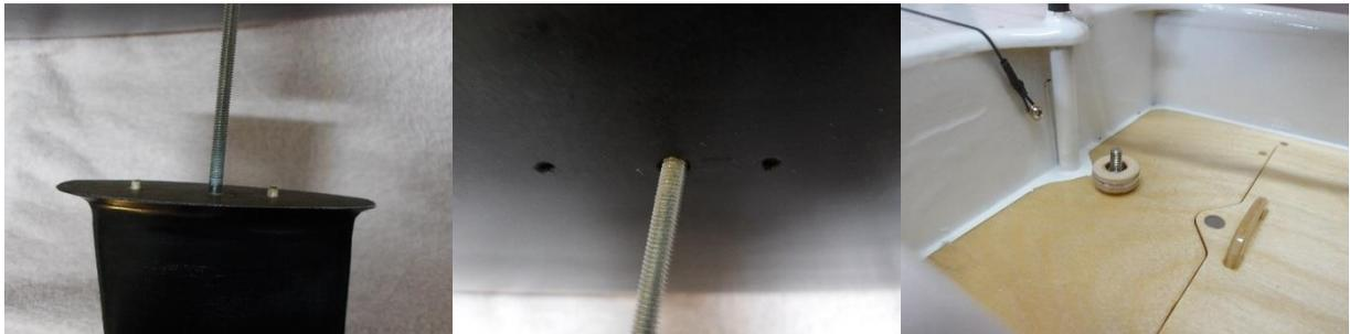
Der Kiel wird montiert. Die beiden Positionierstifte greifen dabei in die Löcher am Rumpf ein.
