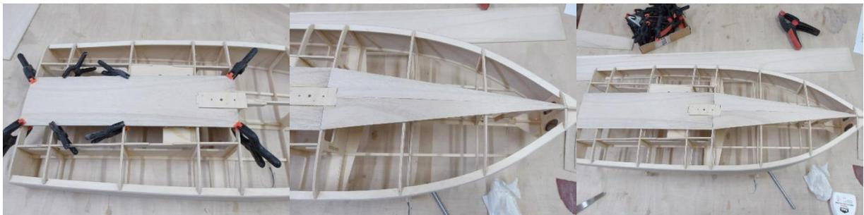
In der Mitte kann großflächig mit einem Balsabrettchen beplankt werden, was Zeit spart. Begonnen wird mit dem hinteren Teil, das eine Aussparung für die Kielplatte 37 bekommt. Am Bug werden zwei dreieckige Beplankungsteile angebracht.
