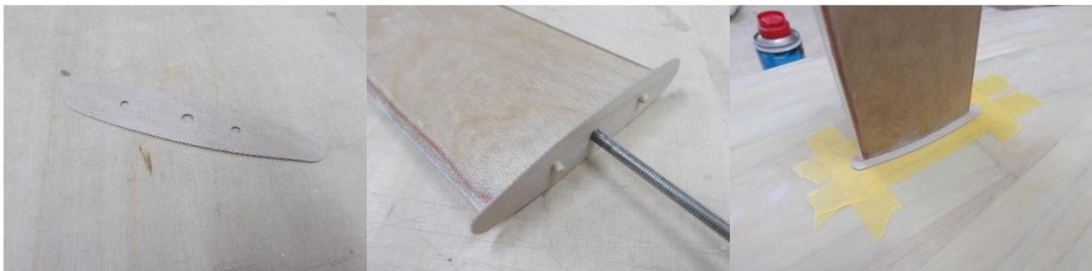
Nach dem Schleifen wird Teil 44 aufgesteckt, die Einheit in die Kielaufnahme des Rumpfes gesteckt und der Rumpf, wie im rechten Bild gezeigt, abgeklebt.
