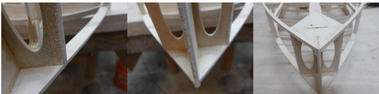
Vor dem Beplanken werden die Spanten im vorderen Bereich und der Vorsteven entsprechen des Verlaufs der Stringer schräg angeschliffen.
