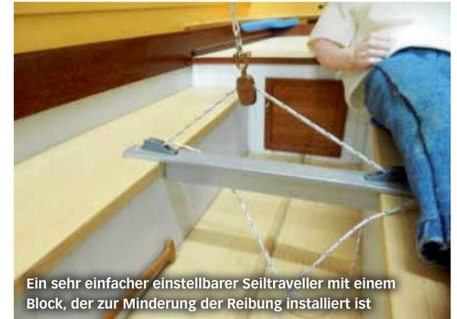
Ein sehr einfacher einstellbarer Seiltraveller mit einem Block, der zur Minderung der Reibung installiert ist
