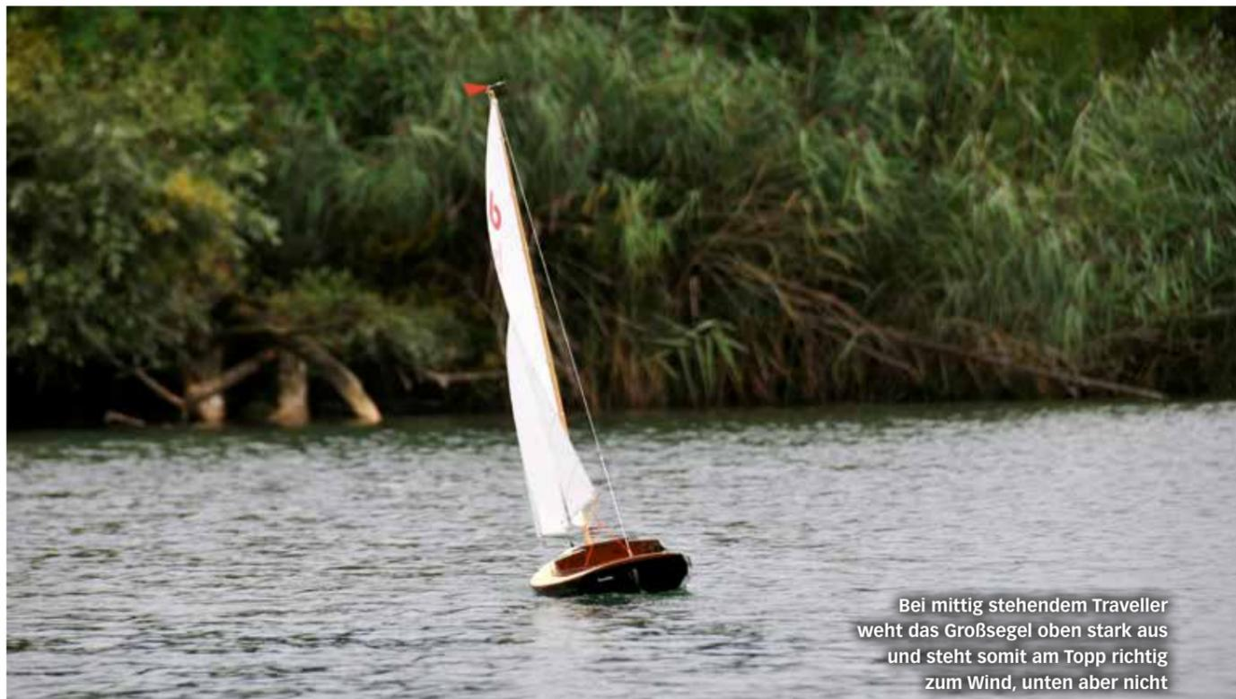
Bei mittig stehendem Traveller weht das Großsegel oben stark aus und steht somit am Topp richtig zum Wind, unten aber nicht
