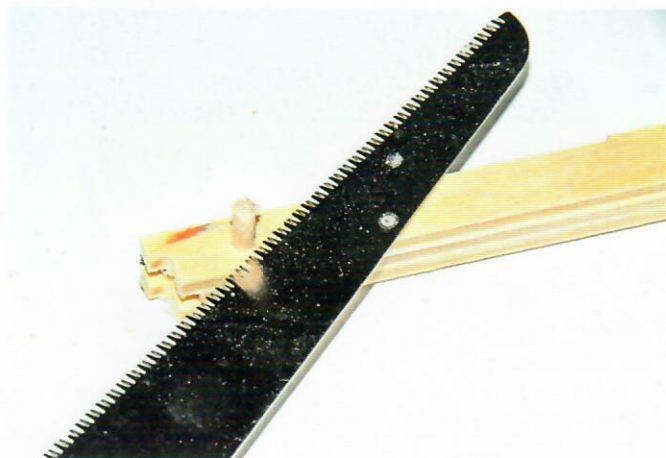
Auch hier werden die Dübel abgesägt und dann eben geschliffen
