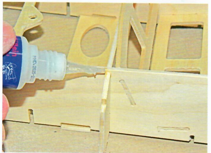
Anschließend wird das zusammengesteckte Gerüst mit Sekundenkleber verklebt
