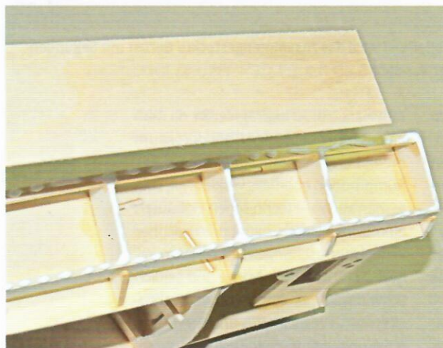
Die seitlichen Beplankungen werden aufgeklebt ...
