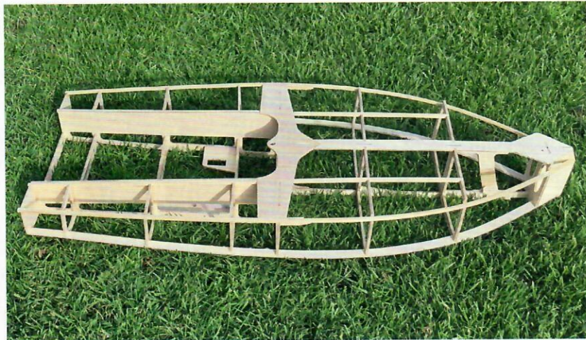
Nach relativ kurzer Bauzeit steht das Rumpfundgerüst und lässt die spätere Form bereits erkennen. Die Passgenauigkeit garantiert einen perfekten Rumpf
