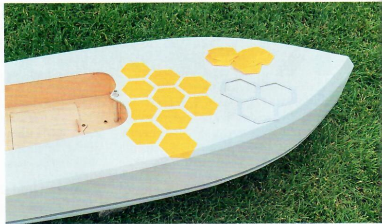
Um gleiche Abstände zwischen den Waben zu erzielen, ist eine Schablone hilfreich
