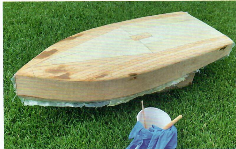
Wasserdichtigkeit lässt sich erst durch eine Lage Glasfasermatte und Harz erzielen. Das macht man an der frischen Luft und mit Einweghandschuhen
