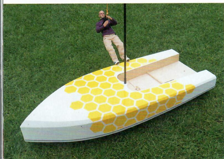
Die Waben sind platziert und der Mast ist gesetzt, anschließend folgte das Ausrüsten mit Baum, Beschlag und Segel
