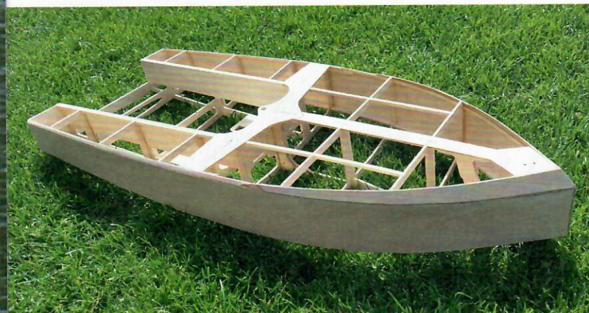
Beplankungsmaterial ist aus dem eigenen Fundus beizusteuern. Hier zu erkennen ist die nach eigenen Vorstellungen modifizierte Rumpfkante im Bugbereich
