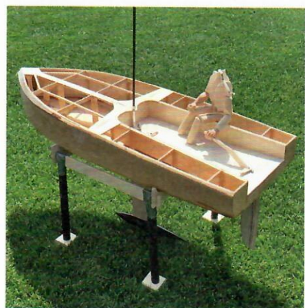
Behelfsmäßig ist der Modellständer mit PVC-Rohren und Holzfüßen zum Einbau von Ruder und Kiel aufgestockt
