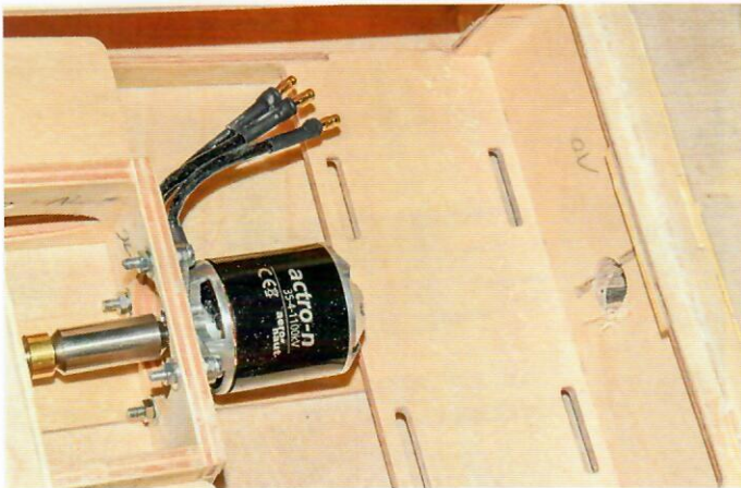
Die Bohrung am vorderen Spant war nötig, um die Welle einfädeln zu können. Sie wurde später einfach zugeklebt
