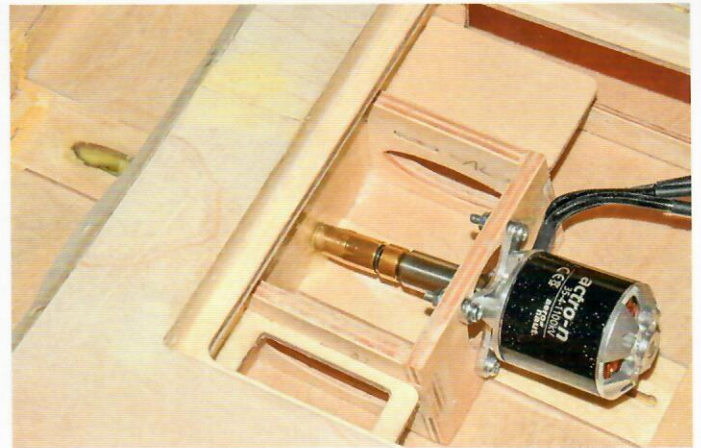
Motor und Welle sind samt Kupplung spannungsfrei ausgerichtet. Jetzt kann der Kleber trocknen
