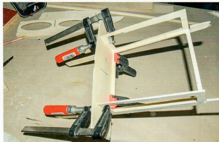
Schon beginnt der Zusammenbau des Rumpferüsts
