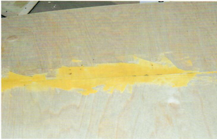
An ein paar wenigen Stellen habe ich kleine Unebenheiten oder nicht exakt passende Kanten verspachtelt
