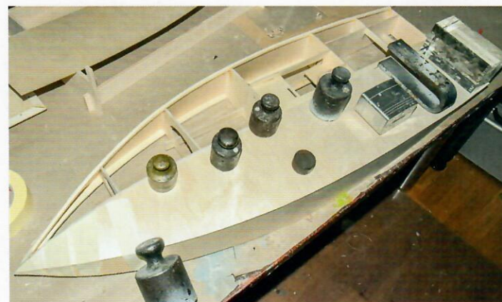
Auch das Aufkleben des Rumpfbodens macht dank der flachen Form keine Schwierigkeiten
