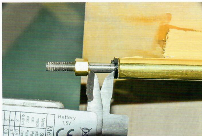
Um dieses kleine Stück muss die Welle gekürzt werden
