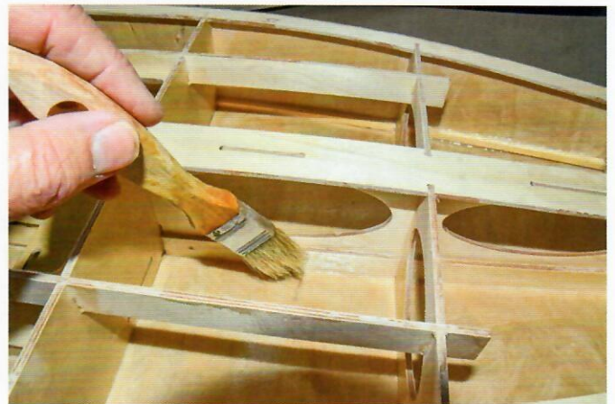
Der gesamte Innenraum wird vor dem Aufkleben des Decks mit Harz oder ähnlichem komplett versiegelt
