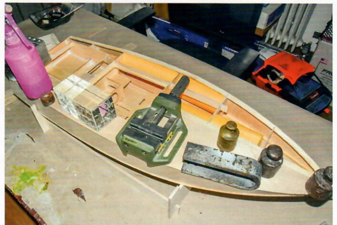
Das Verleimen des Decks: Alles, was schwer genug ist, kann zum Fixieren eingesetzt werden
