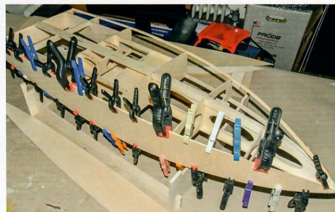
Schnell hat man das Rumpferüst fertig und die seitlichen Bordwände beplankt
