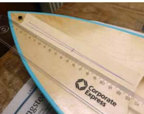
Durch Anzeichnen wird die exakte Position der Umlenköse gefunden
