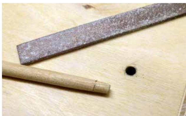
... außerdem saß die Bohrung im Boden zu weit vorn und musste wieder geschlossen werden
