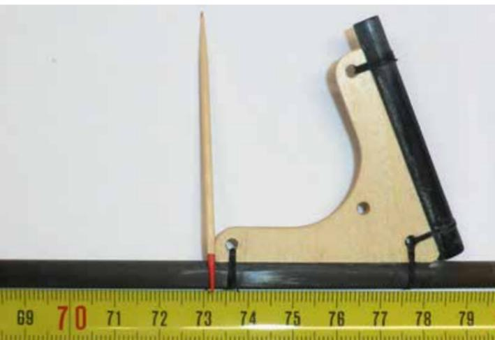
Mit einem Holzwinkel und Schnur werden Mast und Baum verbunden
