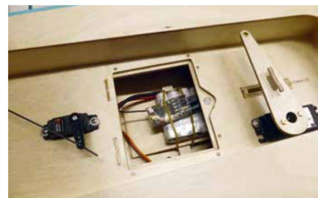
Mit einem Gummiband werden der Akku und der Empfänger gesichert
