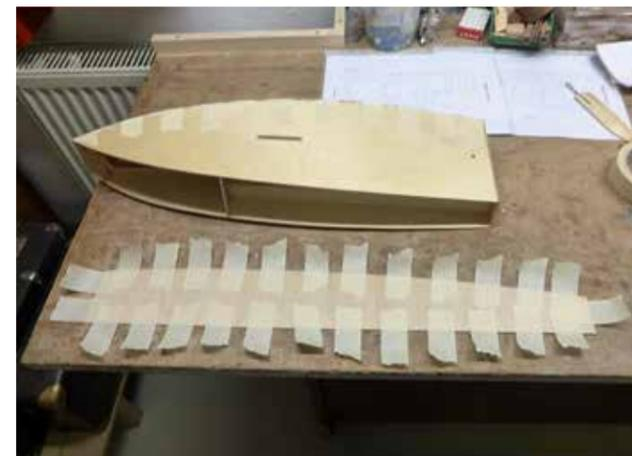
Zum Schluss des Rumpfbaus werden die Seitenteile aufgeklebt
