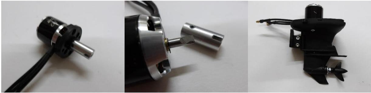
Der Außenbordmotor wird gemäß Anleitung mit dem Antriebsmotor und dem Propeller versehen. Es wird empfohlen die Motorwelle im Bereich der Madenschraube abzuflachen. Der Motor wird nun gewogen.
