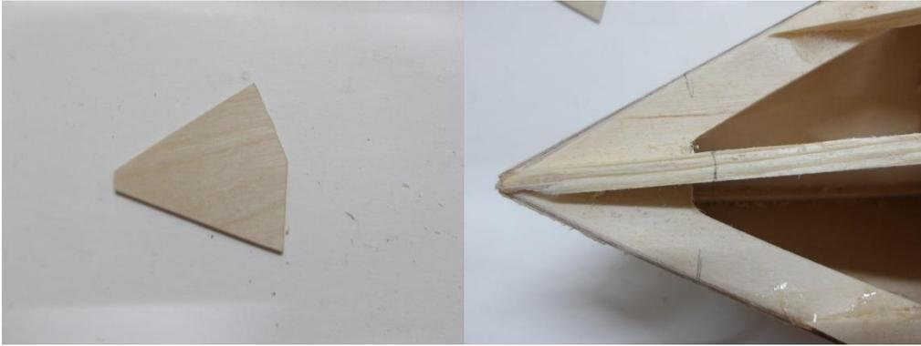
Die Position der Bugbeplankung 27 wird angezeichnet...
