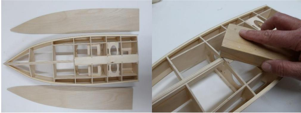
Vor dem Aufbringen der beiden Bodenplanken 26 werden Kiel, Kimmstringer und Seitenplanken gemäß dem Verlauf der Spanten mittels Schleifklotz angepasst.
