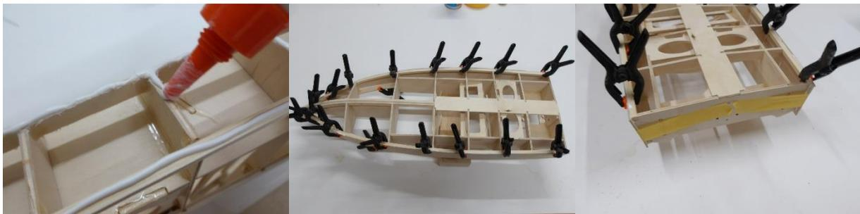
Das Gerippe wird mit Weißleim versehen, die Seitenplanken aufgeklebt und mittels Klammern und Klebeband bis zum Aushärten des Leims fixiert. Es sollten beide Seiten gleichzeitig beplankt werden, um Verzüge zu vermeiden. Die Planken werden dabei am Kimmstringer ausgerichtet und stehen oben über den Decksstringer über.
