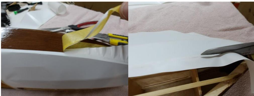
Die überstehende Folie lässt sich dann zusammen mit dem Abdeckband abziehen. In der Mitte kann mit einer Schere besäumt werden.
