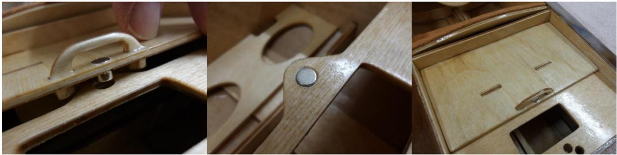
Der zweite Magnet wird auf den ersten gesetzt und zusammen mit dem Deckel im Achterdeck eingepresst. Beide Magnete werden mit Hilfe von dünnflüssigem Sekundenkleber gesichert. Der Deckel sollte mit den beiden Nasen des Haltgriffs im Achterdeck eingreifen und durch die Magnete sicher gehalten werden.
