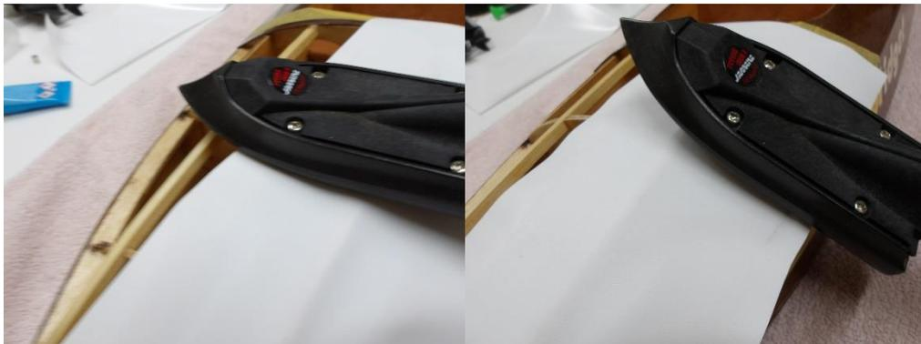
Mit ziehenden Bewegungen wird die Folie vom seitlichen Vordeckstringer zum mittleren Decksstringer gezogen und an selbigem festgebügelt. Ebenso wird nach außen verfahren.
