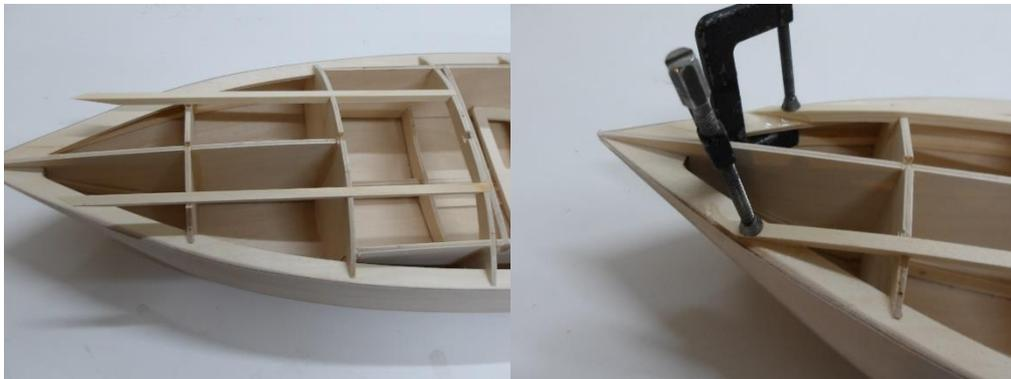
Die beiden Stringer werden zunächst mit den Spanten verklebt. Sobald der Kleber ausgehärtet ist, werden sie mittels Schraubzwingen gebogen und mit den Decksstringern verklebt.
