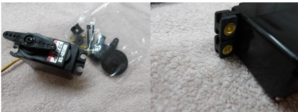
Das Ruderservo wird mit den beiliegenden Gummitüllen und Hohlkugeln versehen.
