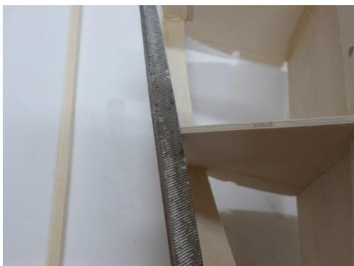
Die Ausparungen des Bugspants werden entsprechend dem Verlauf der Kimmstringers leicht angeschrägt.
