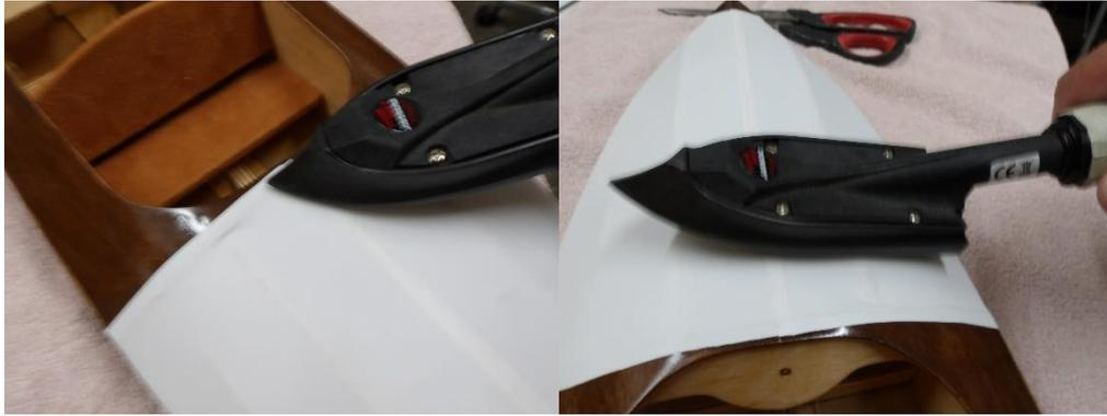
Die Ränder werden mit 150 °C festgebügelt (Haushaltbügelleisen 2,5 Punkte) und die Folie mit der gleichen Einstellung zwischen den Stringern durch langsames Überstreichen mit dem Bügeleisen ohne Druck gespannt.
