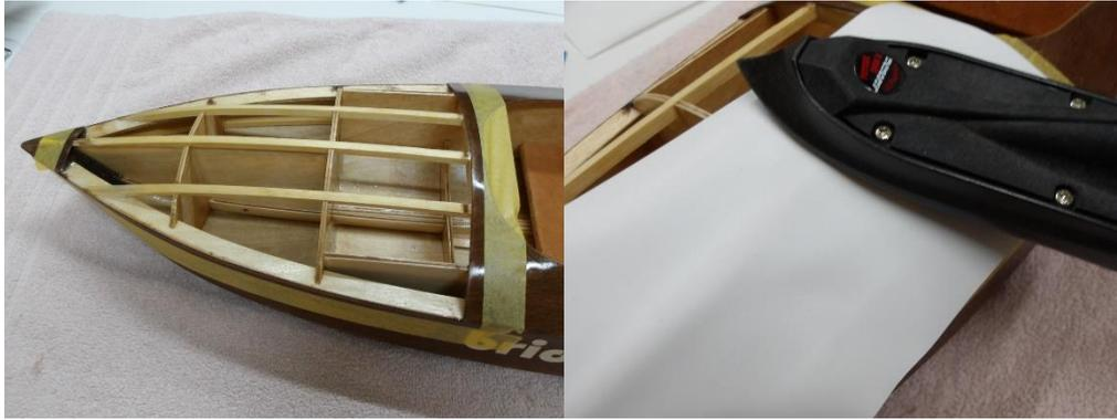
Rings um das Vordeck wird mit Abdeckband abgeklebt. Es sollte etwa 5 mm Fläche für die Verklebung der Vordecksbespannung vorgesehen werden. Die Bügelfolie wird von der Trägerfolie befreit und mit reichlich Überstand nach allen Seiten auf einer Deckshälfte aufgelegt. Sie wird dann am seitlichen Vordeckstringer mit 100 °C festgebügelt.
