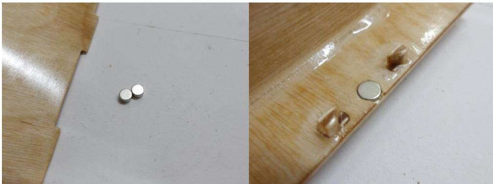
Die Bohrungen für die Magnete werden mit einem scharfen Bohrer auf 6 mm vorsichtig aufgebohrt und einer der Magnete im Deckel eingepresst.
