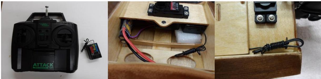
Als Fernsteuerung ist eine einfache Ausführung mit zwei Kanälen ausreichend. Der Empfänger wird nach dem Verkabeln mit etwas Verpackungsmaterial unter dem Achterdeck verklemt. Die Antenne wird auf das Achterdeck verlegt.
