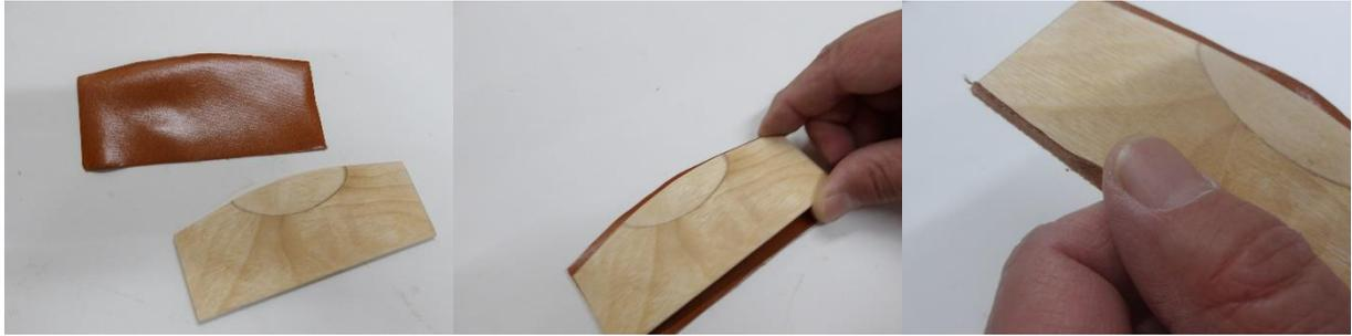
Die Schutzfolie wird vom Alcantara-Bezug abgezogen und der Bezug auf eine ebene Fläche gelegt. Das Teil 31 wird mit der abgerundeten Seite nach unten mittig auf dem Bezug positioniert und angedrückt. Die Kanten werden mit dem Daumen umgeschlagen. Mit Teil 32 wird ebenso verfahren.
