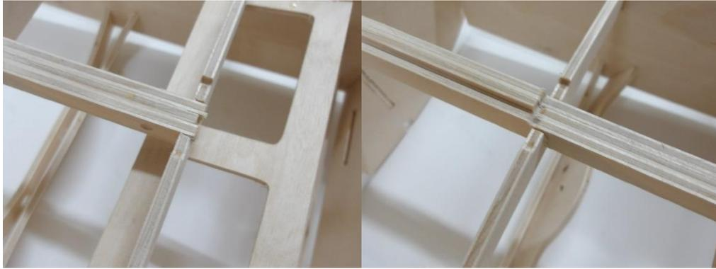
Kontrollieren, ob der Kiel sauber in den Aussparungen der Spanten liegt und alle Teile miteinander mittels dünnflüssigem Sekundenkleber verkleben.
