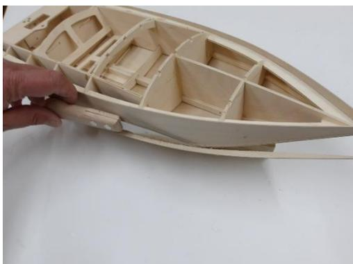
Alle Überstände der Planken werden abgesägt und verschliffen.
