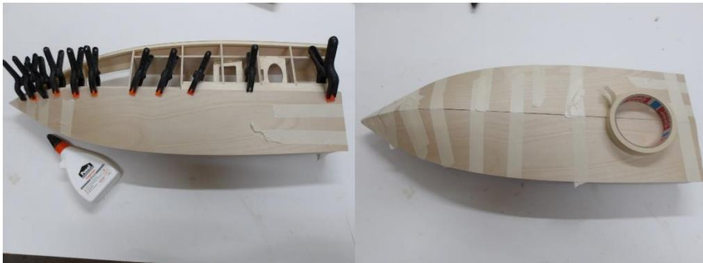
Mit Weißleim wird zunächst eine Hälfte der Beplankung aufgebracht. Sie wird an der Mittellinie ausgerichtet und mit Klebeband und Klammern fixiert bis der Leim ausgehärtet hat. Die zweite Hälfte folgt auf die gleiche Weise.
