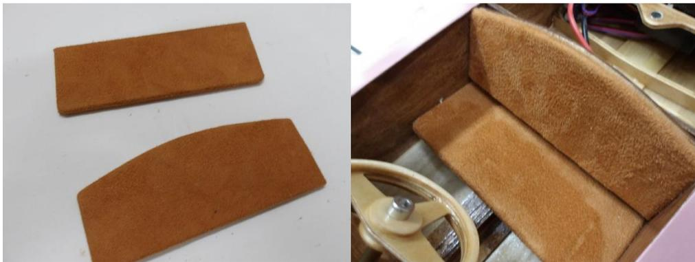
Die beiden Polster werden auf den Unterbau geklebt. UHU-hart ist hier eine gute Wahl.
