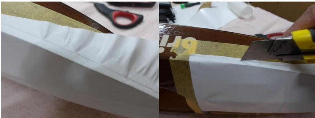
Durch das Abdeckband wird die Schnittkante sichtbar, an der die überstehende Folie mit einem sehr scharfen Messer abgeschnitten wird.
