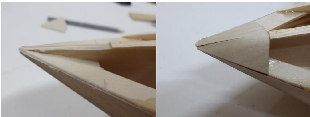
... und der mittlere Decksstringer 1 mm ausgearbeitet. Die Bugbeplankung wird aufgeklebt.
