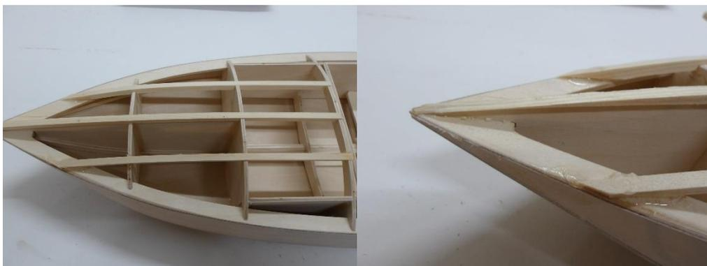
Aus der zweiten kurzen Kiefernleiste entsteht der mittlere Decksstringer, indem sie auf den Kiel geklebt, abgelängt und vorne wie im rechten Bild gezeigt keilförmig abgehobelt wird.
