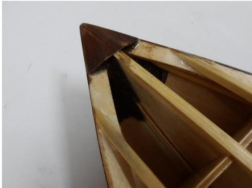
Wiegt der Außenborder 100 g, so ist keine weitere Maßnahme nötig. Jedes Gramm über dieser Angabe muss im Bug mit der gleichen Masse ausgeglichen werden. Beispiel: Wiegt der Motor 150 g, so sind  $150\text{ g} - 100\text{ g} = 50\text{ g}$  im Bug zuzugeben und sicher mit Harz zu vergießen. Hier im Bild gezeigt, sind 50 g Eisenkugeln von Krick, es kann aber auch jedes andere Material verwendet werden.
