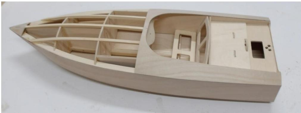
Nach dem Entfernen der Überstände und Verschleifen ist der Rohbau fertig.
