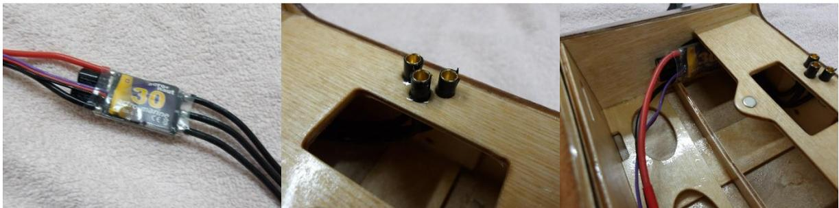
Der empfohlene Regler ist mit 4 mm Goldbuchsen zum Anschluss des Motors vorgesehen. Sie werden mit Sekundenkleber in die drei Bohrungen im Achterdeck eingeklebt. Der Regler wird mit etwas doppelseitigem Klebeband an der rechten Seitenwand des RC-Raums befestigt.
