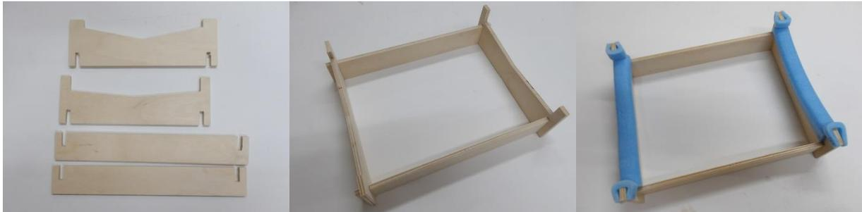
Der Ständer wird aus den Teilen 1, 2 und 3 zusammengesteckt, mittels Weißleim verklebt und mit den Modellauflagen versehen.
