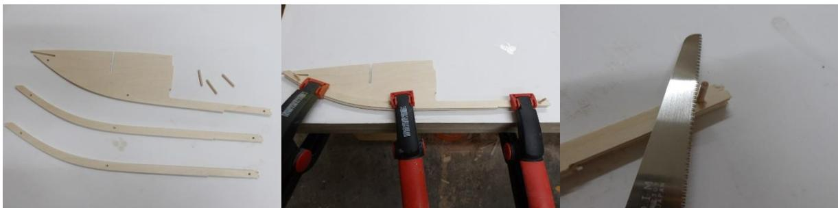
Die beiden Kielverstärkungen 5 werden beidseits des Kiels 4 mittels Weißleim verklebt. Kleine Dübel aus dem 3 mm Rundstab helfen dabei zur genauen Positionierung. Zum Aushärten des Leims wird die Einheit auf eine ebene Platte gespannt, damit kein Verzug entstehen kann. Die überstehenden Dübel werden nach dem Aushärten des Leims abgesägt.
