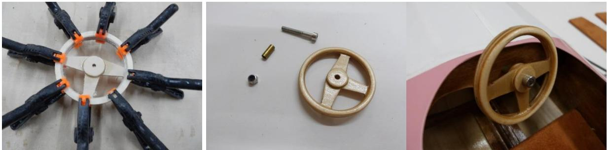
Das Steuerrad entsteht aus den beiden Teilen 29 und den Teilen 30 + 31. Es wird nach dem Aushärten des Klebers verschliffen, lackiert und mit der M4 Schraube, der Abstandshülse und der selbstsichernden Mutter montiert.
