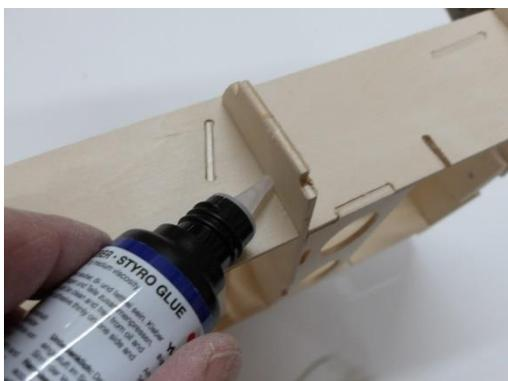
Jetzt erst erfolgt das Verkleben der Teile mittels dünnflüssigem Sekundenkleber. Dazu wird zuerst kontrolliert, ob kein Verzug eingebaut wurde und alle Teile nur geringe Spalte zueinander haben. Sollen die Teile später innen gebeizt werden, erfolgt die Verklebung
