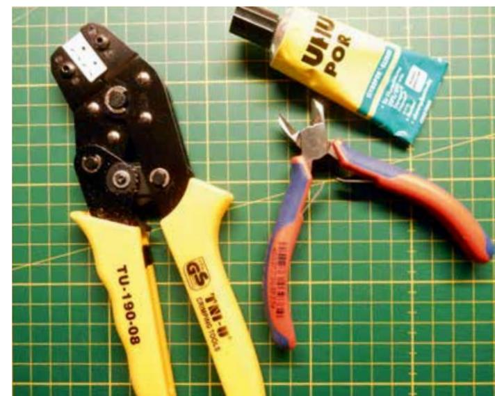
Viel Werkzeug wird nicht benötigt. Die Crimpzange kann ich nur jedem empfehlen, der gerne Servokabel und BEC-Kabel selbst konfektioniert
