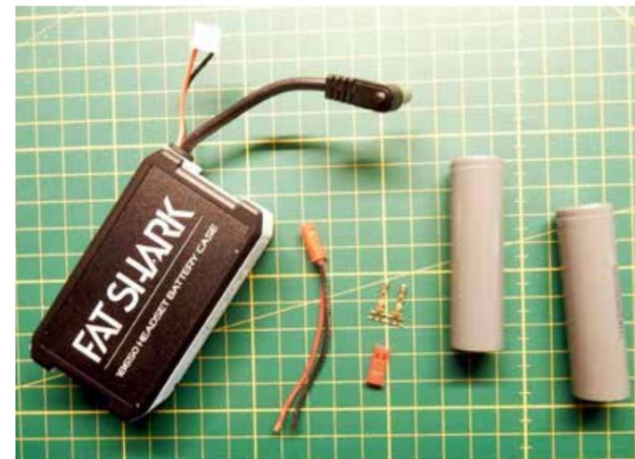
Alle Zutaten zum Seglertglück auf einen Blick. Wer keine Crimpzange hat, greift zu fertigen BEC-Kabeln, die dann einfach an die Kabel der Box gelötet werden
