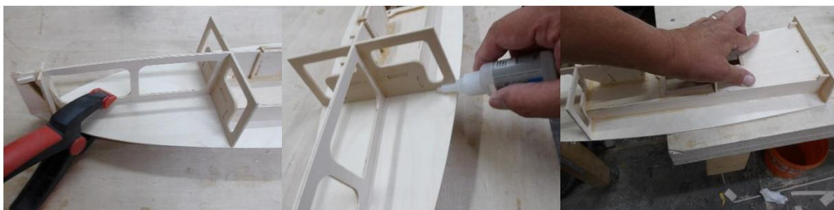
Klammern helfen beim Fixieren. Vor dem Verkleben nochmal kontrollieren, ob alles gerade ist. Zunächst werden der Vorsteven und Spant 20, von vorne beginnend, mit dem Deck mittels dünnflüssigem Sekundenkleber verklebt. Dann wird es mit den Cockpit Seitenwänden und dem Spiegel verklebt. Hier genügt das Andrücken an einer Tischkante, um Spaltfreiheit zu erzeugen.
