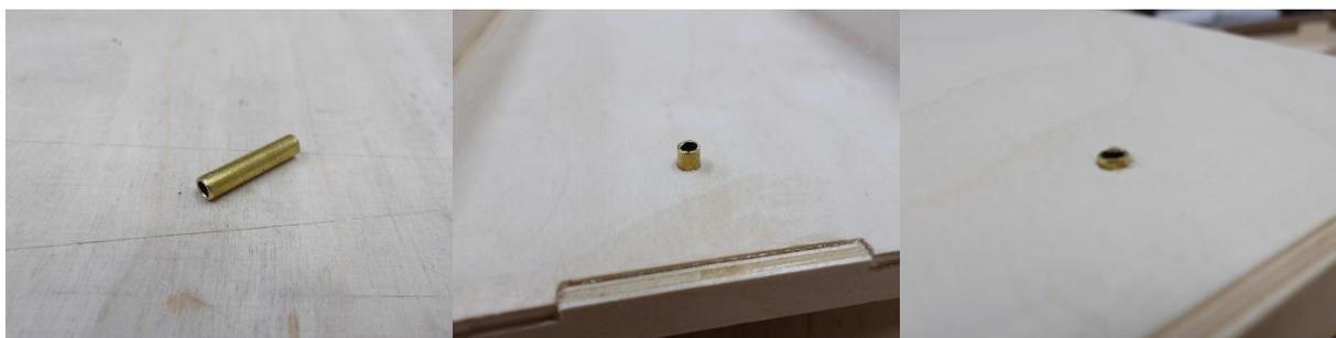
Das kleine Messingrohr wird entgratet. Es bildet den Ruderker, der in die Bohrungen eingeführt, so ausgerichtet wird, dass er am Cockpitboden 1 mm übersteht. Passt alles, wird er zur Befestigung von innen und außen verklebt.
