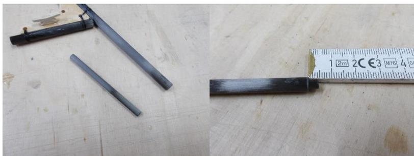
Das kurze Rohstück mit 4 mm Durchmesser bildet den Mastfuß. Es wird am unteren Ende des Masts so eingeklebt, dass es 5 mm Überstand hat.
