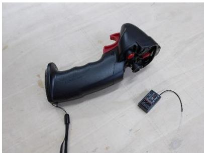
Die RC-Anlage wird eingebaut. Ein kleiner Zweikanal-Einhandsender ist völlig ausreichend für das Boot. Der Empfänger findet seinen Platz unter dem Magnet. Dahinter wird der Akku platziert. Beides wird mit Klettband oder doppelseitigem Klebeband befestigt.
