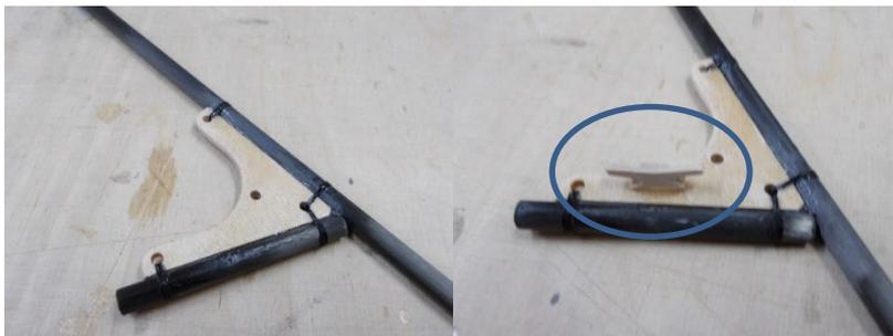
Teil 28 wird mit dem Mast und der Baumhülse mit dem Nähgarn verbunden und die ganze Einheit mit dünnflüssigem Sekundenkleber nochmal verklebt. Eine der Belegklampen 31 wird angebracht.
