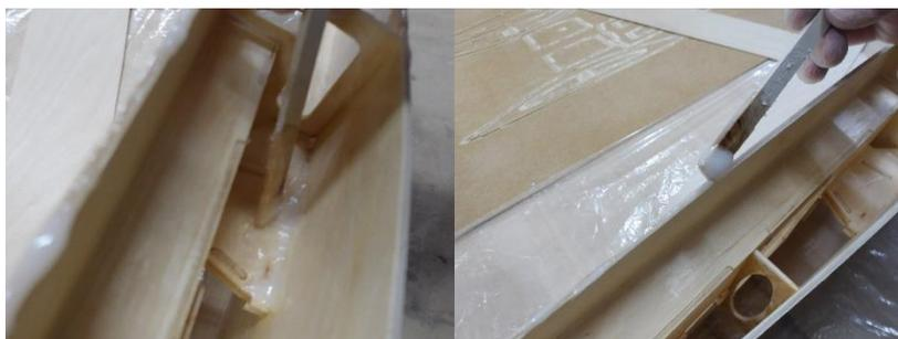
Der Schwertkasten und der Spiegel werden von innen mit angedicktem Harz mit dem Boden vermufft. Die beiden Bordwände 34 werden ebenfalls mit angedicktem Harz mit Deck, Boden, Spant 18 und 20, sowie dem Spiegel verklebt.
