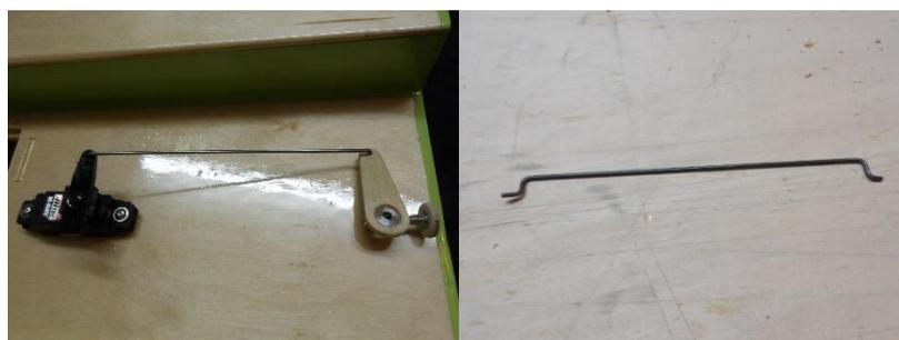
Das Ruderservo wird eingebaut und der Stahldraht an beiden Enden so gekröpft, dass der Abstand der Kröpfungen gleich dem Abstand zwischen Servoachse und Ruderschaft ist. Die so entstandene Schubstange wird auf beiden Seiten wie abgebildet eingehängt.
