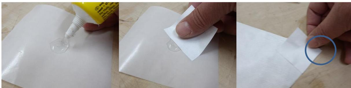
Ein Tropfen UHU kraft wird auf die gewachste Seite des Wachspapiers getropft und das kleine Quadrat gleichmäßig mit dem Kleber benetzt. Es wird nun so auf das Schothorn geklebt, dass eine Kante bündig mit einer Kante des Segels ist und eine Ecke sich genau in der Ecke des Segels befindet.
