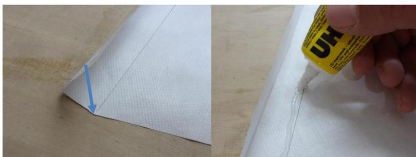
Das Vorliek wird so gefaltet, dass die Kante mit dem Bleistiftstrich bündig ist. Der Knick muss absolut gerade sein. Je sorgfältiger hier gearbeitet wird, umso besser steht das Segel später. Entlang der Kante wird dünn UHU kraft aufgetragen.
