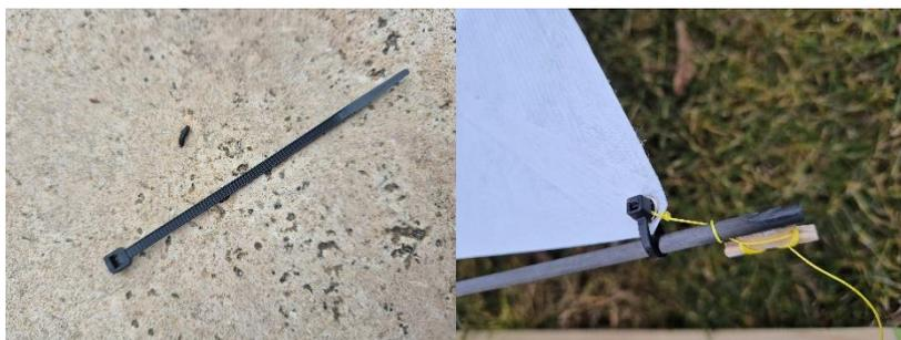
Tuningtipp: Der Stand des Großsegels wird verbessert, indem man es mit einem kleinen Kabelbinder (nicht enthalten) am Großbaum locker befestigt, so dass das Schothorn leicht auf dem Baum rutschen kann.
