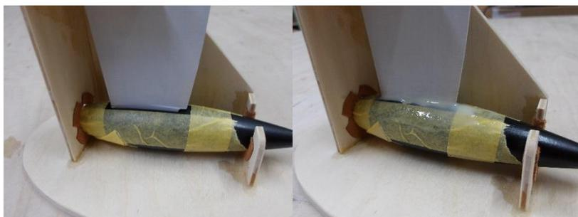
Das Schwert wird in den Ballast gesteckt. Oben muss es mit der Vorderkante (die gerade Kante ist vorne) am Ständer anliegen. Passt alles, wird das Schwert wieder herausgenommen, der Schlitz mit angedicktem Harz gefüllt und das Schwert wieder eingesteckt, bis es unten ansteht. Übergequollenes Harz wird so abgewischt, dass eine kleine Hohlkehle entsteht. Nach dem Aushärten des Harzes kann der Kiel entnommen, geschliffen und lackiert werden.
