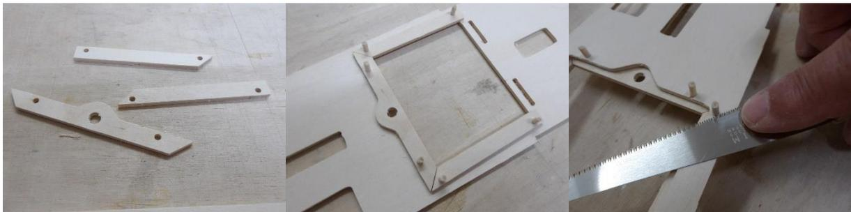
Mit ihnen wird der Rahmen vom Decksausschnitt (Teile 1+2) von der Unterseite mit dem Deck 3 verstiftet und verklebt. Nach dem Aushärten des Klebers werden die überstehenden Enden des Rundholzes bündig abgesägt.
