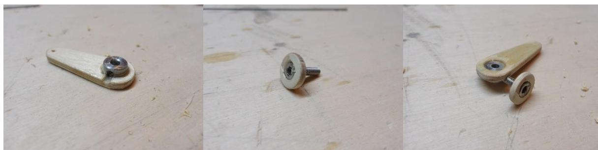
Am Ende des Ruderhebels wird ein 1,5 mm Loch gebohrt. Wie im linken Bild zu sehen, wird an der Position der Bohrung, vor dem Einkleben des Stellrings, eine Kerbe gefeilt. Der Stellingring wird wie abgebildet mit Sekundenkleber in den Ruderhebel 30 geklebt.
