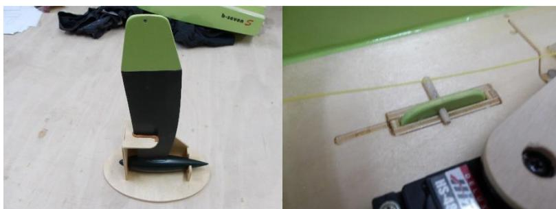
Der Kiel wird in den Ständer gestellt und das Boot aufgesetzt. Mit einem kurzen Stück 3 mm Rundstab wird der Kiel gesichert. Der Stab sollte in der Bohrung leicht klemmen.
