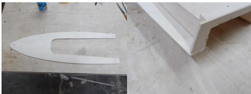
Das Deck 23 wird auf eine ebene Platte gelegt und die eben fertiggestellte Baugruppe kopfüber so auf das Deck gelegt, dass es vorne in die Nase des Vorstevens einrastet. Hinten soll es bündig mit dem Spiegel abschließen. Auch die Cockpitseitenwände werden so ausgerichtet, dass sie bündig mit dem Ausschnitt des Decks abschließen. Das Deck soll auch auf dem Vorsteven spaltfrei anliegen.
