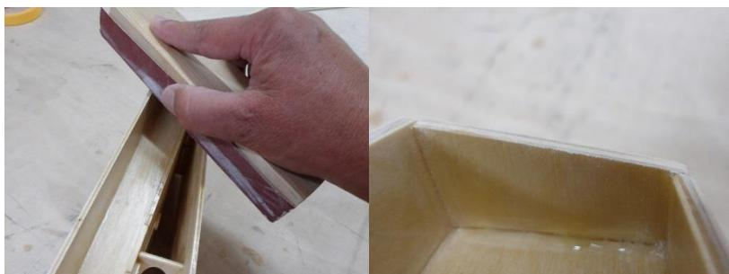
Die Kanten von Deck und Boden werden so angeschliffen, dass sie mit den Spanten bündig sind und eine Schräge haben auf der die Bordwand satt aufliegt. Der Innenbereich und die Innenseiten der Bordwand werden mit Porenfüller imprägniert.
