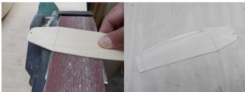
Auch das Schwert wird nun zwischen den Markierungen profiliert. Es wird dazu wie beim Ruderblatt vorgegangen. Beide Teile werden mit Porenfüller imprägniert.
