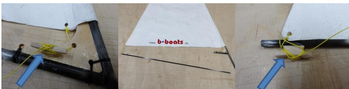
Der Vorliekstrecker (links) wird durch die Bohrung geführt und wie auf dem Bild gezeigt belegt.
