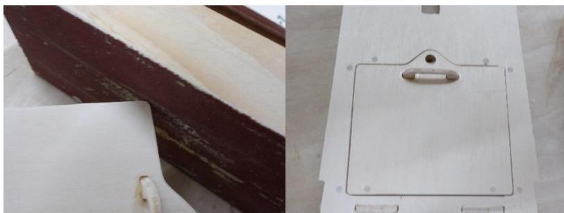
Die Kanten und Ecken des Deckels werden etwas angeschliffen, sodass der Deckel mit gleichmäßigem Spalt in den Decksausschnitt passt.
