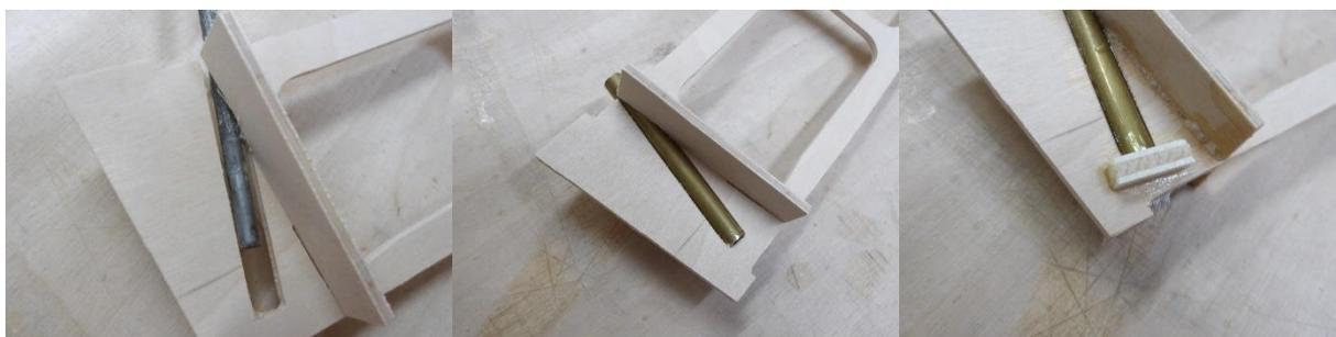
Teil 18 ist mit einer Feile dazu leicht nachzuarbeiten. Passt alles, werden die Teile verklebt und das Messingrohr beidseitig mit Reststücken unten verschlossen. Alternativ zu den Reststücken kann das Messingrohr unten auch zugelötet, oder mit einem Tropfen UHU-endfest verschlossen werden.
