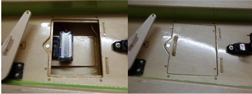
In die Löcher des Deckels und des Rahmens wird je ein Magnet eingepresst. **Vorsicht, auf die Polung achten!**
