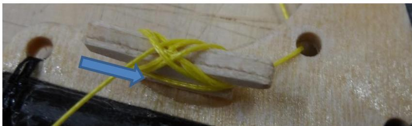
Hier ist nochmal im Detail zu sehen, wie eine korrekt belegte Klampe aussieht. Das Seil wird ein halbes Mal um den Fuß der Klampe geschlungen, dann kreuzweise um die Arme der Klampe geschlungen und das lose Ende bei der letzten Schlaufe unten durchgeschoben (Pfeil). Richtig gemacht geht das nicht von alleine auf.
