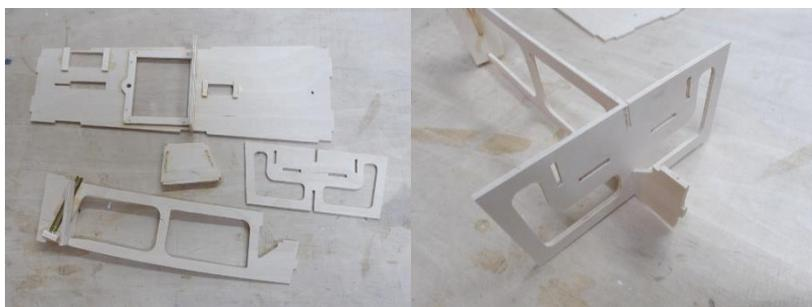
Weiter geht es mit der Montage der Baugruppen des Schwertkastens, des Cockpitbodens und des Vorstevens mit Spant 20. Dazu wird Spant 20 zunächst auf den Vorsteven gesteckt.
