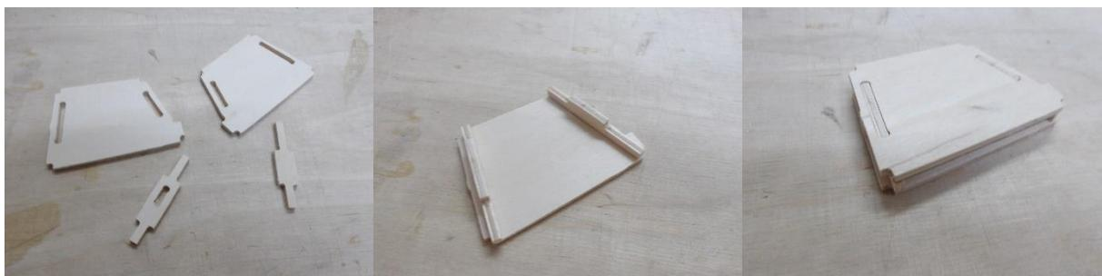
Der Schwertkasten entsteht aus den beiden Teilen 9, sowie den Teilen 10 + 11. Zunächst werden die Teile 10 + 11 so in das eine Seitenteil 9 gesteckt, dass die Enden bündig mit den Kanten von Teil 9 sind. Dann wird die Baugruppe und das zweite Teil 9 von innen mit drei Schichten Porenfüller gegen Feuchtigkeit imprägniert. Nach jedem Anstrich wird mit Schleifpapier mit 150er Körnung zwischengeschliffen. Danach wird das zweite Seitenteil 9 aufgeklebt.
