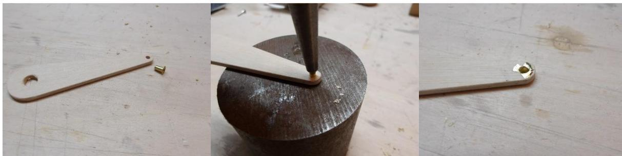
Ein Hohlriet vom Servozubehör wird in das Loch am Ende des Segelverstellarms 29 gesteckt, mit einem Körner aufgeweitet und platt geklopft.
