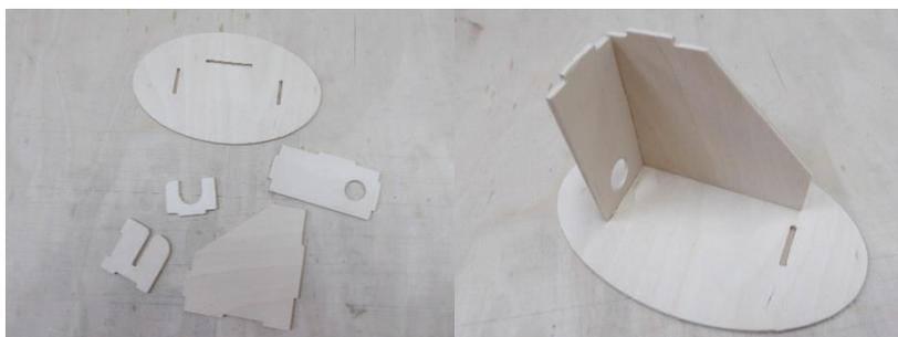
Der Displayständer entsteht aus den Teilen 12 – 17. Zunächst werden die Teile 13 und 14 in Teil 12 gesteckt. Achtung, die Schlitzte in der Grundplatte 12 sind unterschiedlich lang.
