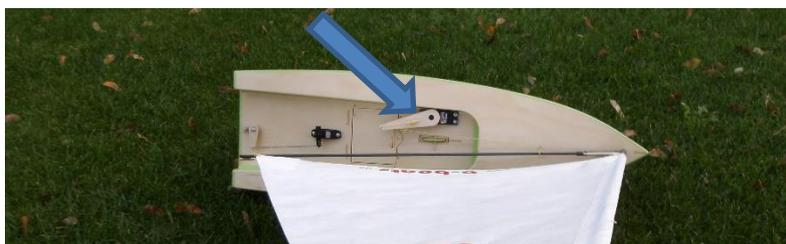
Die Großschot wird bei dichtgeholtem Segelverstellservo so an der Belegklampe belegt, dass der Großbaum möglichst in der Mitte steht. Ganz in der Mitte ist nicht notwendig, ein paar Grad zur Mittellinie sind genug.
