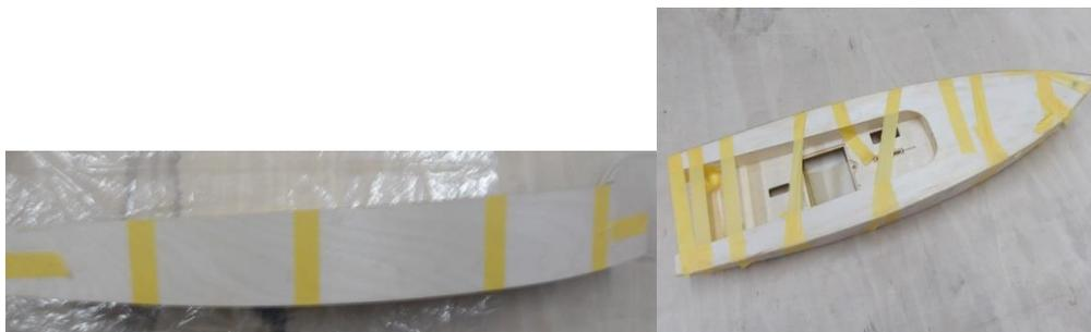
Zum Aushärten sollte nicht zu wenig Klebeband verwendet werden, damit die Teile spaltfrei aufeinander liegen, bis das Harz über Nacht an einem warmen Ort ausgehärtet ist. Nach dem Entfernen des Klebebandes wird der Rumpf verschliffen, der Schwertkasten mit dem Boden bündig geschliffen und von alles außen mittels Porenfüller imprägniert.
