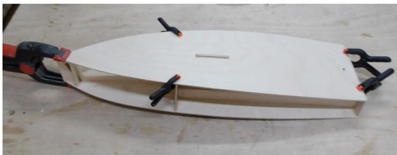
Mit dem Boden 24 wird ebenso verfahren. Er rastet in die Nase am Bug und am Schwertkasten ein. Der Boden soll satt auf Spant 4 aufliegen und ist am Spiegel so zu bearbeiten, dass er bündig abschließt. Der Schwertkasten darf etwas überstehen. Wieder wird mit Klammern fixiert, auf Verzugsfreiheit geprüft und wenn alles passt mit dünnflüssigem Sekundenkleber verklebt.
