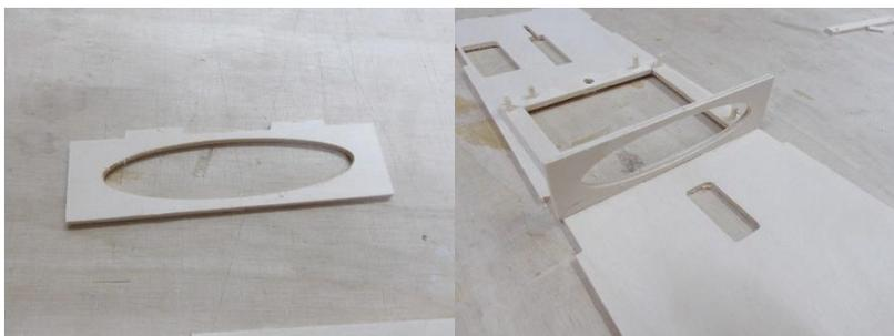
Spant 4 wird ebenfalls von unten mit dem Deck verklebt.
