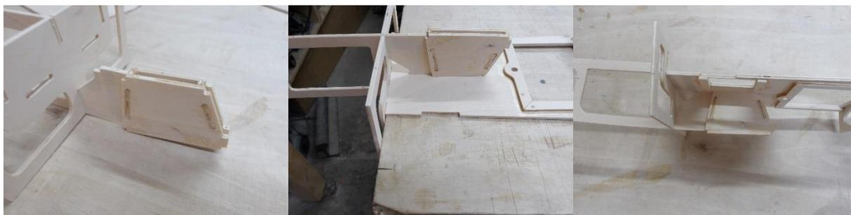
Der Schwertkasten wird mit der Nut (Teil 11) auf den Steven gesteckt. Dann wird der Cockpitboden in Spant 20 gesteckt und der Schwertkasten in seine Aussparung eingeführt. An einer Tischkante wird alles so ausgerichtet, dass zwischen den Teilen keine Spalten entstehen und alles miteinander mit dünnflüssigem Sekundenkleber verklebt.
