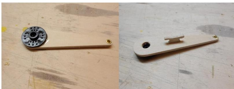
Die runde Scheibe des Servozubehörs wird mit Sekundenkleber auf die Seite des Arms geklebt, auf der sich die gerundete Seite des Hohlriets befindet. Auf die Oberseite wird eine Klampe 31 geklebt.
