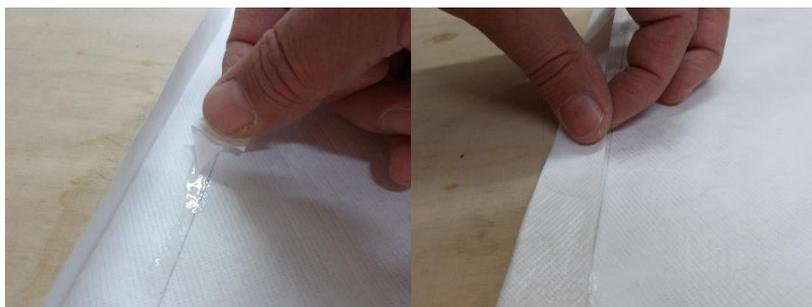
Der Kleber wird mit einem Reststück Segeltuch glattgestrichen. Die Kleberauftrag soll höchstens 5 mm breit sein. Dann wird das Vorliek entlang des Bleistiftstrichs festgeklebt. Wieder muss sehr sorgfältig vorgegangen werden, damit die Klebnaht glatt und gerade wird. In die so entstandene Tasche wird später der Mast eingeführt.
