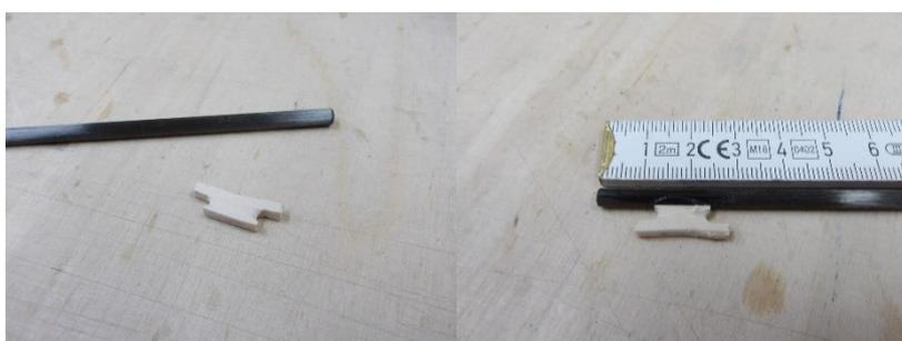
Der Baum besteht aus dem 500 mm langen Rohstück mit 4 mm Durchmesser. Er wird am Ende mit einer Klampe 31 versehen.
