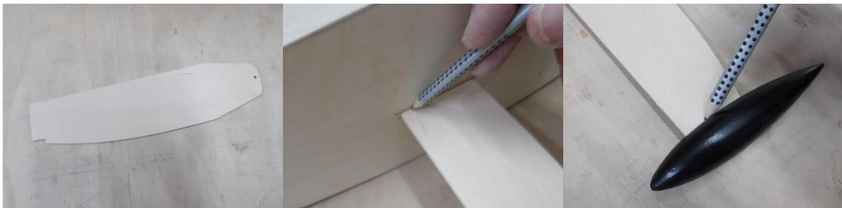
Am Schwert 27 werden zunächst die Positionen des Rumpfübergangs und des Schlitzes im Ballast angezeichnet.
