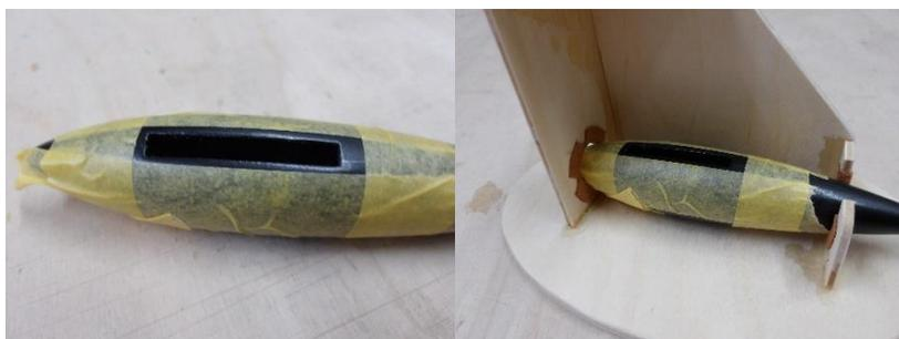
Der Schlitz des Ballasts wird innen etwas angerauht, um den Schlitz herum abgeklebt und wie abgebildet in den Ständer gelegt.
