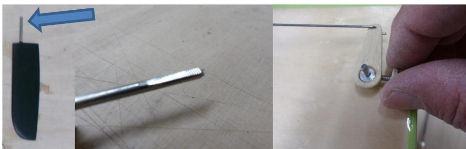
Der Ruderschaft wird auf der hinteren Seite mit einer Feile abgeflacht. Das Ruder von unten in den Ruderkoher geschoben und mit der Schraube im Stellhebel gesichert.
