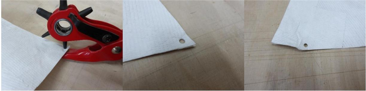
Mit einer Lochzange werden die beiden unteren Ecken des Segels mit einem 3 mm Loch versehen. Der Abstand zu den Kanten bzw. zur Masttasche soll mindestens 3 mm betragen. Falls keine Lochzange vorhanden ist, kann auch ein Locher verwendet werden. Am besten übt man das Löcher machen zuerst an einem Reststück.
