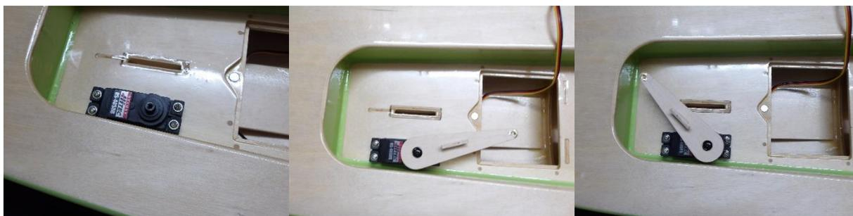
Das Segelverstellerservo wird eingebaut und der Hebelarm so befestigt, dass er für die Stellung „Segel dichtgeholt“ wie auf dem mittleren Bild steht. Bei der Stellung „Segel gefiert“ ergibt sich dann die Stellung im rechten Bild.
