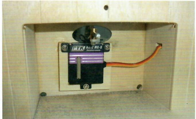
Das Ruderservo wird mit dem Rahmen direkt an den Spiegel geklebt
