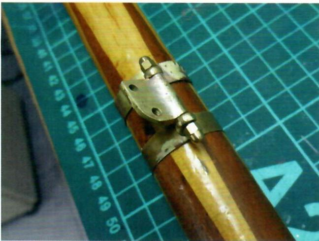
Der Beschlag, der den Großbaum trägt, ist aus Messingteilen gelötet
