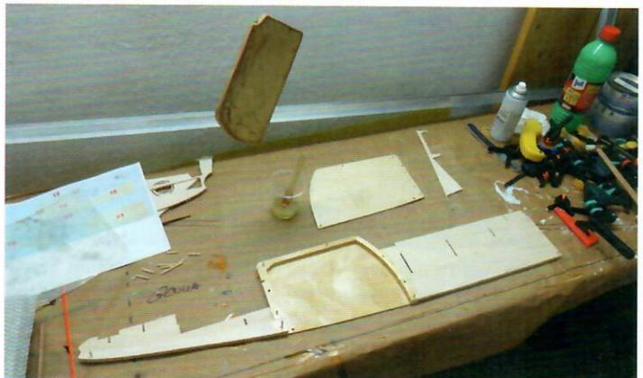
Die beiden Teile für den Kiel sind mit Bohrungen für Führungsstifte versehen
