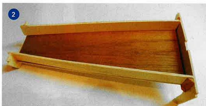
1) In die Mittelsection eingesetzt ist auch das RC-Brett – die Ausschnitte für Servo und Winde sind individuell anzupassen.
