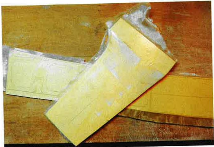
Schwert, Schwertkasten und die Spanten 4 und 6 werden vor dem Zusammenbau mit 80-g/m<sup>2</sup>-Glasgewebe beschichtet
