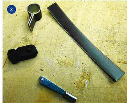
1) Die CFK-Rohre für die Spieren werden an den Enden mit einem 6-Millimeter-Buchendübel verschlossen, der mit dünnflüssigem Sekundenkleber eingeklebt wird. 2+3) Die Manschette um den Mast nimmt das Baumlager auf, das aus Dachdeckeraluminium und Gabelköpfen entsteht
